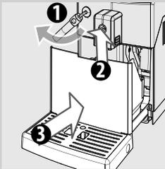
**4** Réinsérer le tiroir à marc dans le bac d'égouttement et replacer ce dernier dans la machine.
