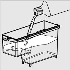
**6** Extraire le réservoir à eau et y verser tout le contenu de la solution détartrante. Puis remplir le réservoir avec de l'eau fraîche jusqu'au niveau calc clean.
