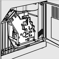
**12** Après avoir rincé le groupe de distribution, l'insérer à nouveau dans son logement jusqu'à l'enclenchement (voir la section « Nettoyage hebdomadaire du groupe de distribution »). Insérer le bac d'égouttement et le tiroir à marc. Fermer la porte de service.
