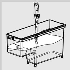
**12** Extraire le réservoir à eau, le rincer et le remplir avec de l'eau fraîche jusqu'au niveau MAX. Le réinsérer dans la machine. La page-écran suivante s'affiche lorsque le réservoir à eau est inséré dans la machine.
