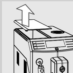
**4** Soulever le réservoir à eau en utilisant la poignée.
