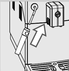
**17** Lorsque le réservoir à eau est vide, l'enlever, le rincer et le remplir d'eau fraîche jusqu'au niveau MAX. Le réinsérer dans la machine.
