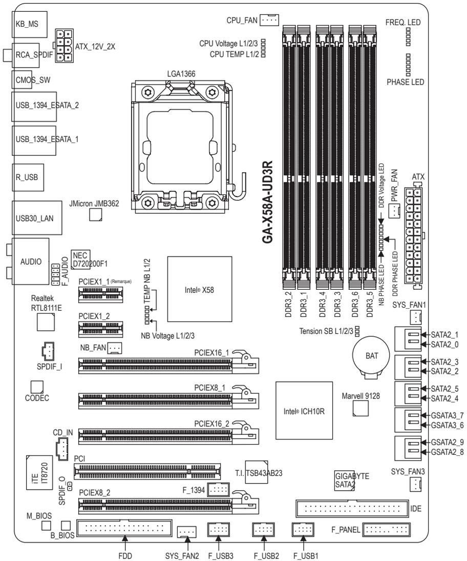
(Remarque) A cause des limites du logiciel, la fente PCIEX1\_1 ne peut être utilisée qu'avec une petite carte d'extension PCI Express x1. Utilisez les autres fentes si vous avez une grande carte d'extension.
