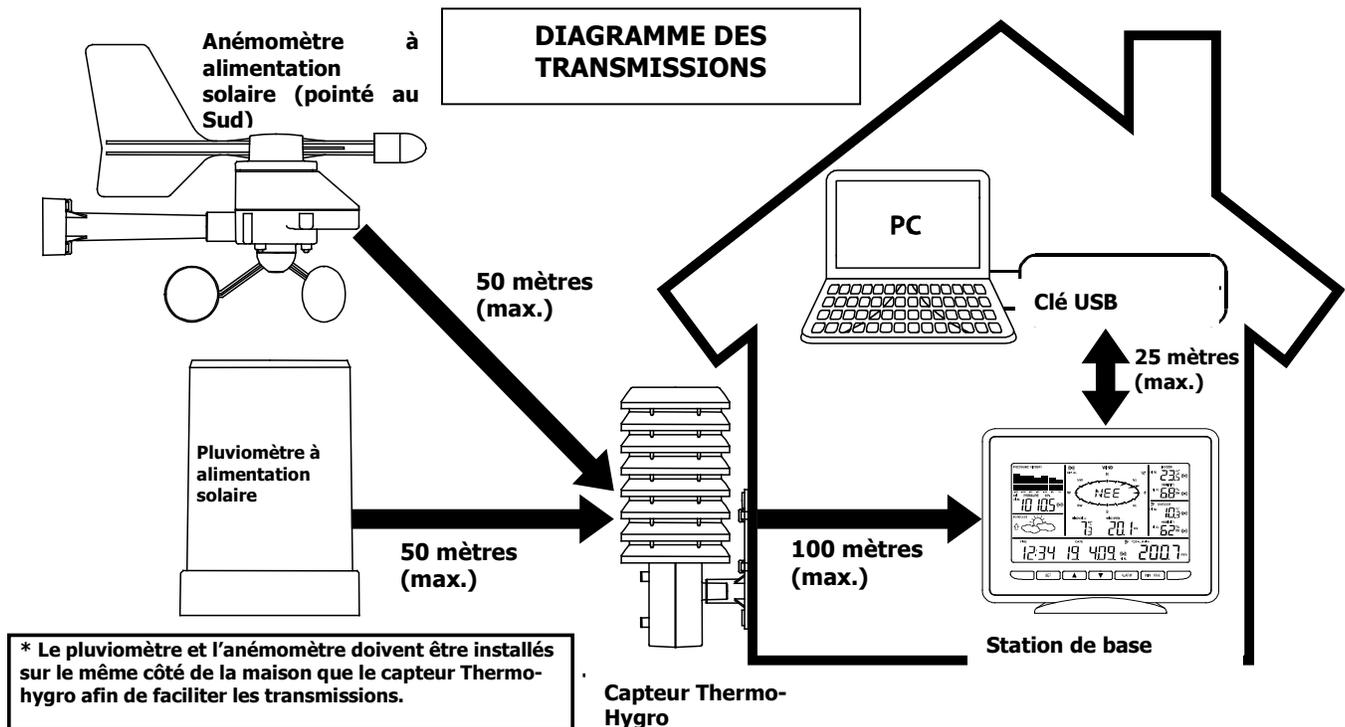
Le capteur thermo-hygro relève la température et l'hygrométrie extérieures et centralise aussi les données du pluviomètre et de l'anémomètre, puis envoie toutes les données à la station de base. Le capteur thermo-hygro a une portée de **100 mètres, en champ libre**. L'installation du pluviomètre et de l'anémomètre doit donc se faire par rapport au capteur Thermo-hygro, et non par rapport à la station de base. Consultez le diagramme des transmissions ci-dessus.
