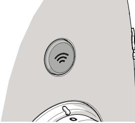
Appuyez sur le bouton Pulse pour mixer à la vitesse maximale. Parfait pour les opérations les plus complexes. Il peut être utilisé pendant un maximum de 2 secondes à la fois.
