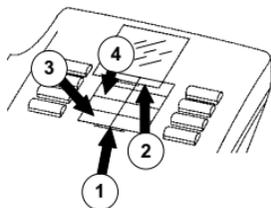
① Insérez un objet à bout plat dans l'encoche.
