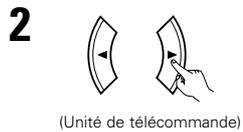
Réglez la distance entre l'enceinte et la position d'écoute. La distance change en unité de 0,1 mètre chaque fois que la touche est enfoncée. Sélectionner la valeur la plus proche de la distance mesurée.
