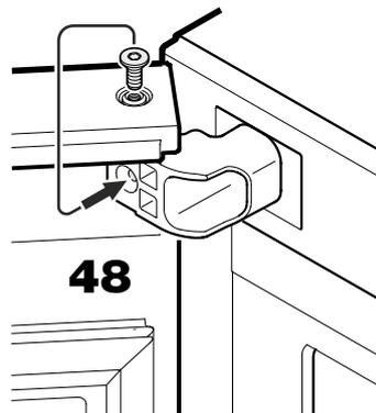
48. Sortir la vis du pivot et la visser dans l'orifice du support.
