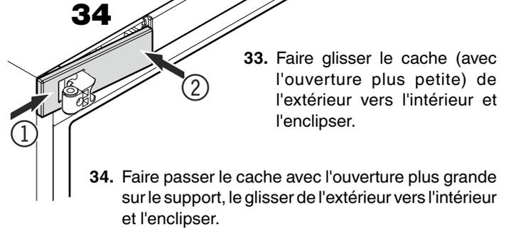
34. Faire passer le cache avec l'ouverture plus grande sur le support, le glisser de l'extérieur vers l'intérieur et l'enclipser.
