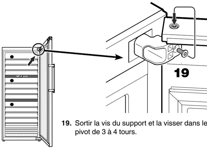
**19.** Sortir la vis du support et la visser dans le pivot de 3 à 4 tours.
