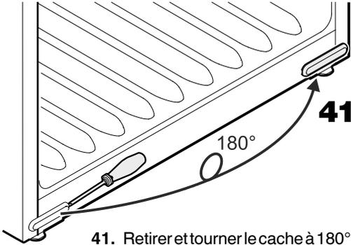
41. Retirer et tourner le cache à 180° pour le positionner sur le côté opposé.
