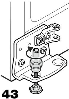
43. Mettre en place le pied réglable par en dessous et visser le pivot.
