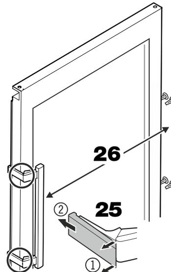
**25.** Désclipser les plaques de pression à l'avant ① et les retirer vers l'arrière ②.
