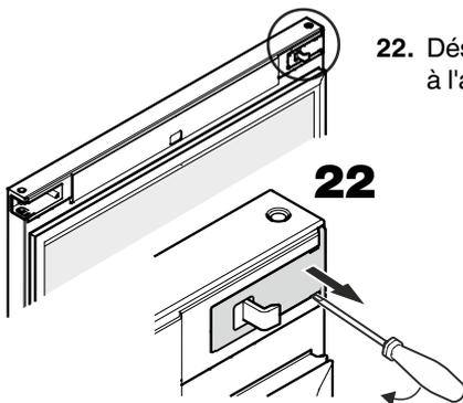
**22.** Désclipser et retirer le cache à l'aide d'un petit tournevis.
