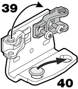
39. Poser le support pour l'amortisseur de fermeture sur le côté opposé du support.
