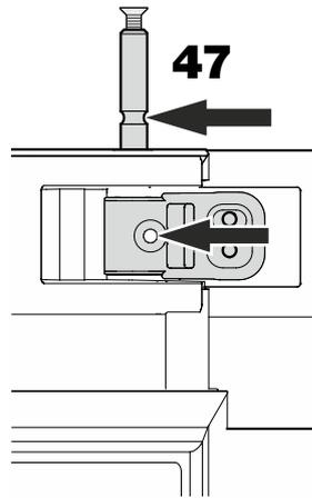
47. Insérer le pivot jusqu'à ce que l'encoche du pivot soit alignée avec l'orifice du support.
