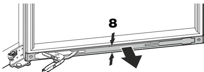
8. Appuyer sur le milieu du cache et le déclipser. Retirer le cache.
