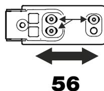
56. Desserrer les vis et déplacer le support vers la droite ou la gauche. Serrer les vis à fond.
