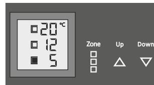
À l'aide de la touche **Zone**, sélectionner le compartiment dans lequel la température doit être modifiée.
