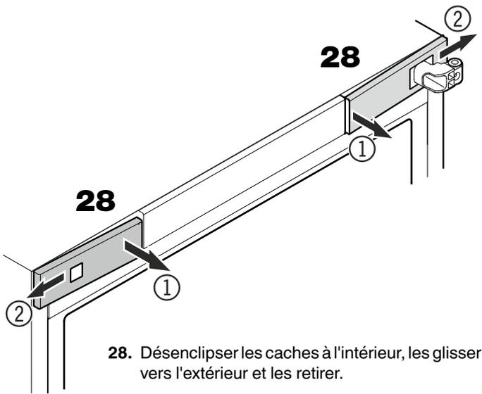
28. Désenclipser les caches à l'intérieur, les glisser vers l'extérieur et les retirer.
