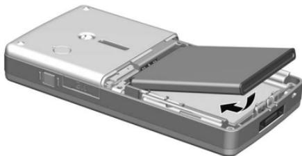
Pour retirer le cache de la batterie, appuyez légèrement sur la partie supérieure et faites glisser le cache le long du téléphone. Insérez la batterie et fermez le cache.
