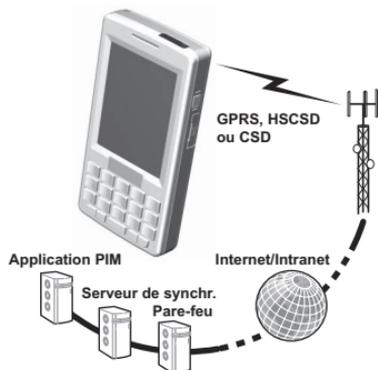
On appelle synchronisation distante la procédure de synchronisation entre un téléphone et un serveur de synchronisation basé sur Internet ou sur un réseau Intranet. Cela vous permet de synchroniser votre téléphone lors de vos déplacements. Pour configurer et lancer la synchronisation distante, sélectionnez **Outils > Synchronisation distante**.
