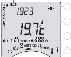
Lorsque le symbole d'usure des piles apparaît, vous disposez d'environ 1 mois pour changer celles-ci (2 piles alcalines 1,5V de type LR03 ou AAA).
