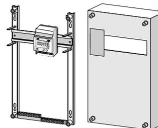
Fixation sur rail DIN, boîtier modulaire et T.I dans le tableau électrique.
