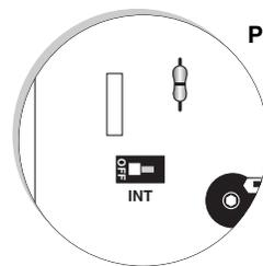
Pour un abaissement de - 3,5°C, l'interrupteur "INT" doit être mis en position OFF.
