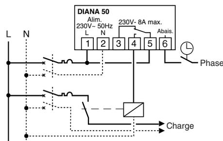
Le relais est à dimensionner en fonction de la puissance à piloter
