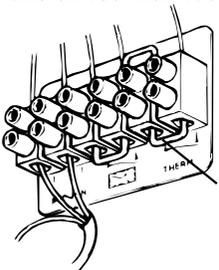
Enlevez le shunt et raccordez les bornes 4 et 5 du thermostat directement.
