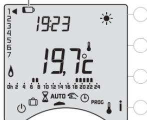
Les piles doivent être changées lorsque le symbole d'usure des piles apparaît (2 piles alcalines 1,5V de type LR03 ou AAA).
