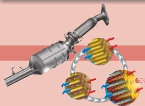
Ce système innovant équipe le moteur 1.5 dCi 106 ch ; il réduit les émissions de particules en les bloquant dans le pot d'échappement. Pour maintenir ce faible niveau d'émissions, le filtre intelligent se nettoie tout seul et automatiquement grâce à un procédé de régénération thermique.
