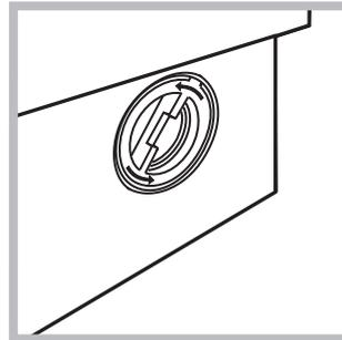
2. dévisser le couvercle en le tournant dans le sens inverse des aiguilles d'une montre (voir figure): il est normal qu'un peu d'eau s'écoule;
