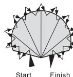
**Remarque :** La phase de chauffe dure au moins 60 secondes. L'appareil passe en mode normal 15 secondes après son activation pour qu'un test déambulatoire puisse être effectué.
