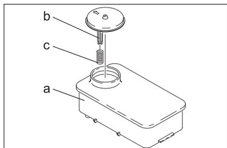
→ Remover a mola (c) do apoio da tampa (b) do recipiente do descalcificador (a).
