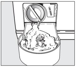
■ Dévissez le filtre jusqu'à ce que de l'eau s'écoule.
