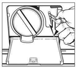
Tirez le déverrouillage de secours vers le bas, par exemple avec le manche d'une cuiller. La porte s'ouvre.
