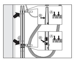
■ Fixez les tiges de transport sur la paroi arrière. Vérifiez que les tenons ♠ s'engrènent dans les trous ๋ ...
