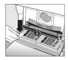
■ Insérez un nouveau filtre "SUPER air clean". Il peut être inséré un côté ou l'autre vers le haut.
