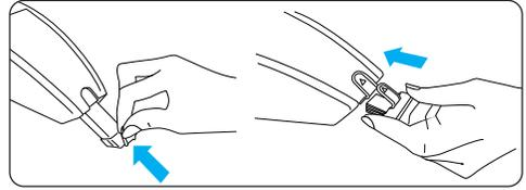
Pour les liquides sur les surfaces lisses, placez la raclette à liquides dans l'ouverture d'aspiration sans retirer le suceur plat.
