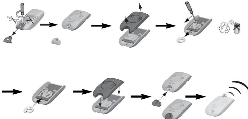
**2. Remplacer le capot de l'éclairage intégré**
