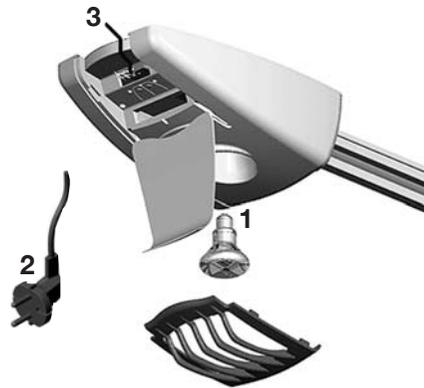
**⚠ L'alimentation électrique doit être équipée d'un dispositif de protection individuelle (déconnexion omnipolaire), exemple, prise de courant femelle.**
