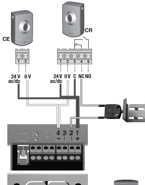
Sans cellules, le kit sécurité portillon est câblé entre les bornes 1 et 2.
