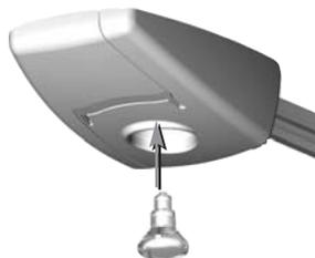
**⚠ Utiliser exclusivement des ampoules du type R80 - 40W - 230V - douille E 27.**
