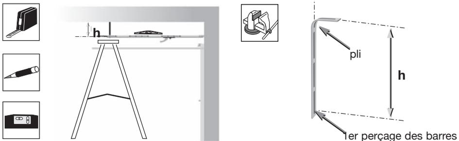
❑ Mise en place des barres d'attache.
