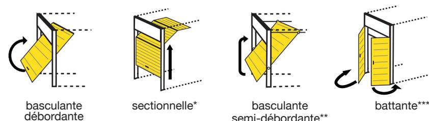
Pour la porte sectionnelle\*, semi-débordante\*\* et porte battante\*\*\*, il est **nécessaire** d'installer les accessoires suivants, **vendus séparément** :
