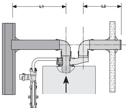
Le système comporte deux conduits séparés (arrivée d'air de combustion et évacuation des produits de combustion), destinés à prendre l'air de combustion directement à l'extérieur et à évacuer les produits de combustion dans un conduit d'évacuation collectif à tirage naturel.
