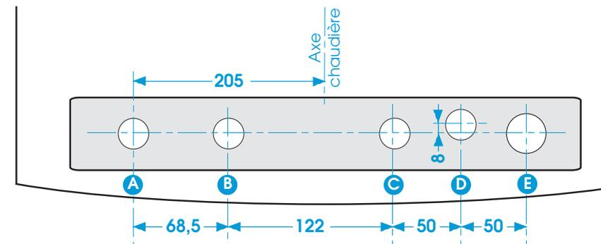
Les tubulures livrées avec la plaque de raccordement permettent de se raccorder à l'installation:
