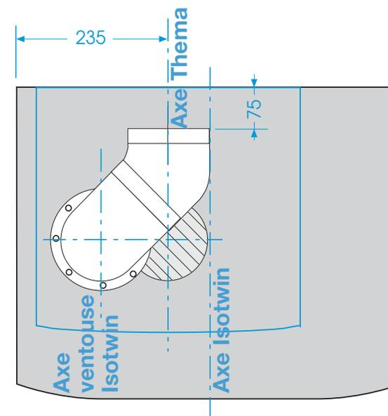
La mise en place de l'ensemble doit être effectuée conformément au descriptif dessiné sur le gabarit.
