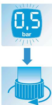
**Attention :** A partir de 2,5 bars le clignotement de l'indicateur (3) signifie que **l'installation est en surpression** : purger un radiateur pour réduire la pression.
