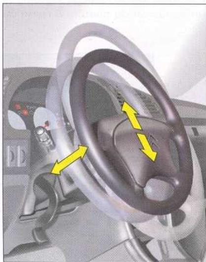
Déverrouillez le volant en poussant la commande vers l'avant.
