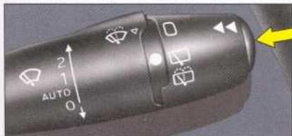
Pour obtenir la sélection des différentes informations et leur affichage, appuyez par impulsion brève sur l'extrémité de la commande de l'essuie-vitre avant.
