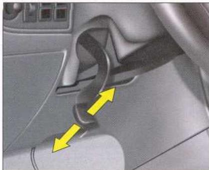
Le volant peut être réglé en hauteur et en profondeur.
