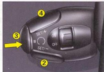
Le régulateur de vitesse, ne doit être utilisé que lorsque les conditions de roulage à vitesse constante le permettent. Ne pas l'utiliser lorsque la circulation est très dense, sur route accidentée, présentant de mauvaises conditions d'adhérence ou toutes autres difficultés.
