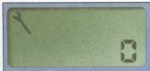
**Remarque :** si le temps maximum entre deux vidanges est atteint avant la limite des kilomètres, la clé de maintenance s'allume et l'afficheur indique «0» passé ce délai.
