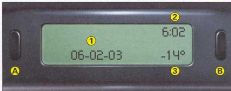
**A** Commande d'accès aux fonctions de l'afficheur.
