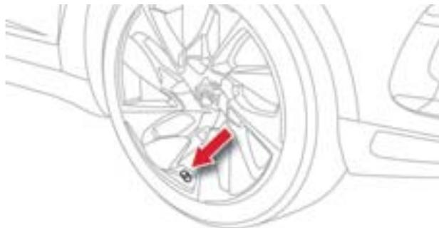
Des capteurs, montés dans chaque valve, déclenchent une alerte en cas de dysfonctionnement (vitesse supérieure à 20 km/h).
