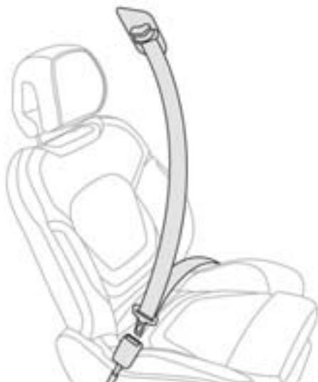
Les ceintures de sécurité avant sont équipées d'un système de prétension pyrotechnique et de limiteur d'effort.
