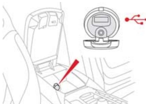
Ce boîtier de connexion, composé d'une prise JACK et USB, est situé dans l'accoudoir avant (sous le couvercle).
