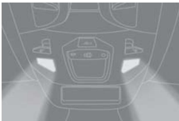
De nuit, les éclairages d'ambiance s'allument automatiquement, dès que les feux de position sont allumés (par exemple une source lumineuse issue de la console de pavillon vient éclairer le milieu de la console centrale). L'éclairage d'ambiance s'arrête automatiquement à la coupure des feux de position.
