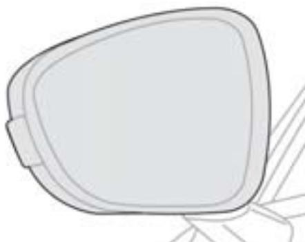
Équipés chacun d'un miroir réglable permettant la vision arrière latérale nécessaire aux situations de dépassement ou de stationnement. Peuvent également être rabattus pour stationner dans un passage étroit.
