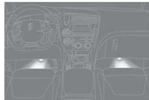
L'allumage tamisé des éclairages de cave à pieds facilite la visibilité dans le véhicule en cas de faible luminosité.
