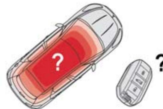
Si la clé électronique n'est plus dans la zone définie lorsque vous roulez ou demandez l'arrêt moteur (ultérieurement), un message apparaît au combiné.
