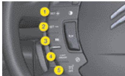
Les commandes du limiteur de vitesse sont situées sur le côté gauche du volant.
