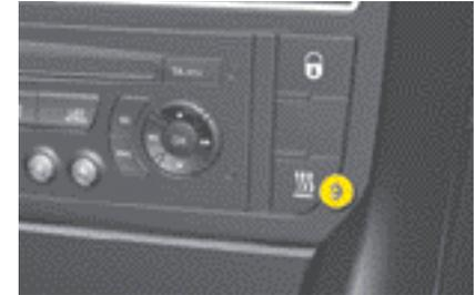
9. Témoin du système de chauffage programmable.
