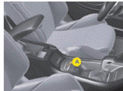
En cas de dysfonctionnement du frein de stationnement électrique ou de panne batterie, une commande mécanique de secours permet de déverrouiller manuellement le frein de stationnement.
