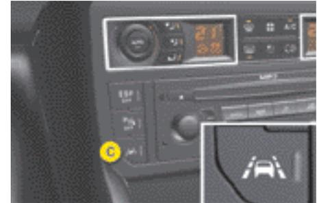
Ce dispositif est conseillé sur les autoroutes et voies rapides, et fonctionne uniquement au-delà d'une vitesse d'environ 80 km/h.
