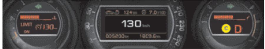
La position du sélecteur et le mode de conduite sont affichés dans le cadran **C** du combiné de bord.
