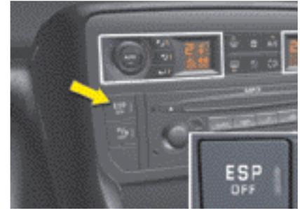
Appuyez sur le bouton «**ESP OFF**», situé au milieu de la planche de bord.
