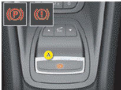
En cas de défaillance du système de freinage principal ou en situation exceptionnelle (exemple : malaise du conducteur, en conduite accompagnée...), tirez et maintenez la palette **A** pour arrêter le véhicule.
