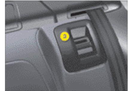
Le voyant rouge de la commande 3 ne doit plus être visible sinon poussez le siège à fond.
