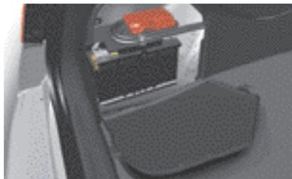
La batterie se trouve dans le coffre sous la garniture de l'aile gauche.
