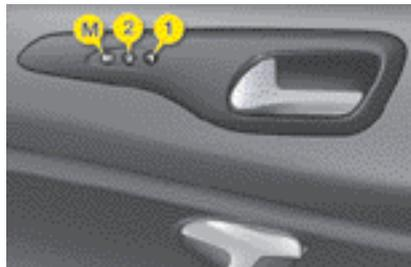
Système prenant en compte les réglages du siège conducteur, des rétroviseurs extérieurs et de la climatisation. Il vous permet de mémoriser jusqu'à deux positions à l'aide des touches sur le côté du siège conducteur.
