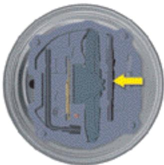
L'anneau de remorquage est installé dans le boîtier de protection du cric placé dans la roue de secours.
