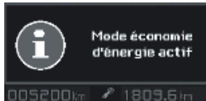
Après l'arrêt du moteur, certaines fonctions (autoradio, essuie-vitres, lève-vitres, toit ouvrant, sièges électriques, téléphone, vidéo, éclairage intérieur, volet de coffre motorisé, etc.) ne sont alimentées électriquement que durant au maximum environ une heure, afin de ne pas décharger complètement la batterie.
