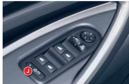
Elle permet de neutraliser les commandes arrière des lève-vitres et l'ouverture des portes arrière de l'intérieur. La sécurité électrique est activée par une impulsion sur la commande J.
