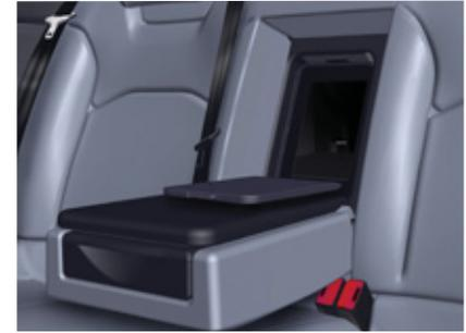
Une trappe dans le dossier situé derrière l'accoudoir permet le transport d'objets longs.
