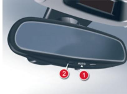
Dans les véhicules équipés de rétroviseurs extérieurs électrochromes, le système dispose d'un interrupteur marche/arrêt et d'un voyant qui lui est associé.
