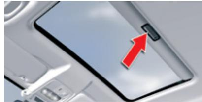
Le toit ouvrant de votre véhicule est équipé d'un volet d'occultation manuel.
