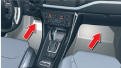
À l'avant, à l'ouverture d'une porte, il permet d'éclairer l'intérieur du véhicule.
