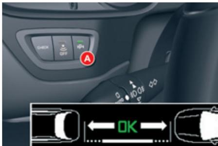
Vous pouvez sélectionner la fonction «Mesure de place disponible» en appuyant sur la commande **A**, indicateur de direction activé du côté de la place à mesurer, vitesse inférieure à 20 km/h et à une distance inférieure d'environ 1,5 m de la place.
