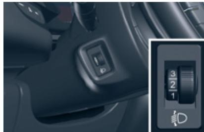
Pour ne pas gêner les autres usagers de la route, les projecteurs à lampes halogènes doivent être réglés en hauteur, en fonction de la charge du véhicule.
