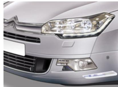
Pour ne pas gêner les autres usagers de la route, ce système corrige, automatiquement et à l'arrêt, la hauteur du faisceau des lampes au xénon, en fonction de la charge du véhicule.
