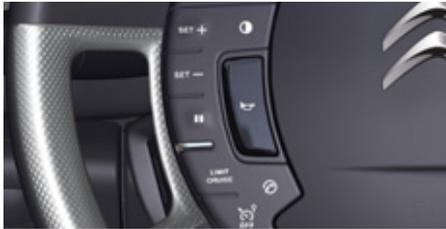
Ce système permet de choisir une vitesse maximale à ne pas dépasser.
