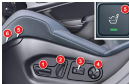
1. Réglages longitudinal, de la hauteur et de l'inclinaison de l'assise du siège.
