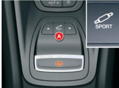
La suspension s'adapte automatiquement et instantanément aux différents types de conduite et au profil de la route, conciliant au mieux le confort des occupants et la tenue de route du véhicule.
