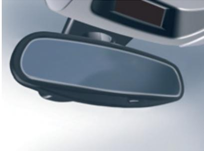
Grâce à un capteur, mesurant la luminosité provenant de l'arrière du véhicule, ce système assure automatiquement et progressivement le passage entre les utilisations jour et nuit.
