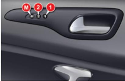
Système prenant en compte les réglages du siège conducteur. Il vous permet de mémoriser jusqu'à deux positions à l'aide des touches sur le côté du siège conducteur.
