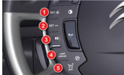
Les commandes du régulateur de vitesse sont situées sur le côté gauche du volant.
