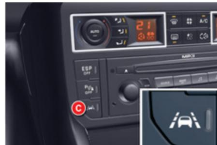
Ce dispositif est conseillé sur les autoroutes et voies rapides, et fonctionne uniquement au-delà d'une vitesse d'environ 80 km/h.
