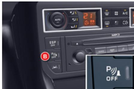
Vous pouvez activer/désactiver l'aide au stationnement par un appui sur la commande **B**. Si l'aide au stationnement est inactive, le témoin de la commande **B** est allumé.
