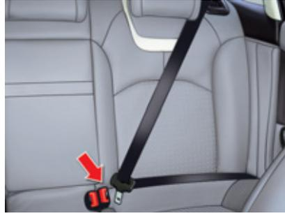
Les places arrière sont équipées de trois ceintures, dotées chacune de trois points d'ancrage et d'un enrouleur avec limiteur d'effort.
