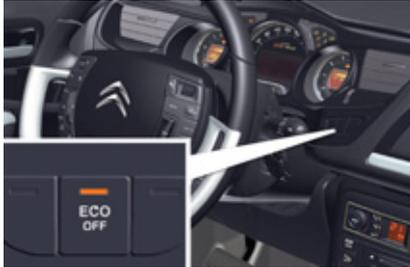
En cas de dysfonctionnement du système, le voyant de la commande «**ECO OFF**» clignote, puis s'allume fixement.
