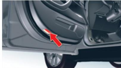
Porte ouverte, il permet d'éclairer le sol à l'extérieur du véhicule.
