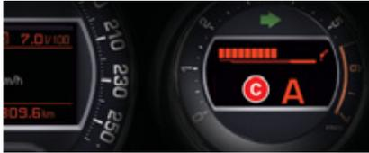
La position du sélecteur et le mode de conduite sont affichés dans le cadran **C** du combiné de bord.
