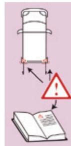
Lors d'un stationnement avec les portes arrière ouvertes à 90°, celles-ci masquent les feux arrière. Afin de signaler votre position aux usagers, circulant dans le même sens qui pourraient ne pas avoir remarqué votre arrêt, utilisez un triangle de présignalisation ou tout autre dispositif prescrit par la législation et réglementation de votre pays.
