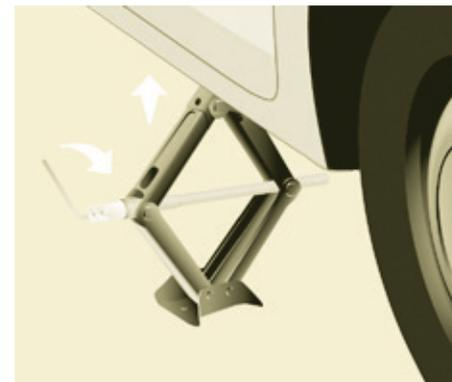
Ne déployez le cric qu'après avoir amorcé le dévissage de la roue à changer, et une fois la cale en place sous la roue diagonalement opposée.
