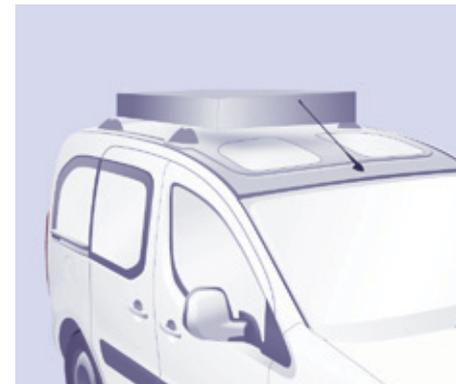
Dans tous les cas, la charge doit reposer sur les bandes anti-dérapantes prévues à cet effet, et ne doit toucher ni le pavillon, ni les vitres de toit.
