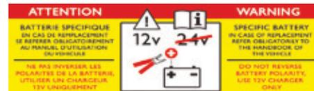
**i** Le Stop & Start fait appel à une technologie avancée. Toute intervention sur ce type de batterie doit être réalisée exclusivement dans le réseau CITROËN ou dans un atelier qualifié.
