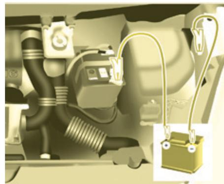
Avant de procéder au débranchement de la batterie, vous devez attendre 2 minutes après la coupure du contact. Ne débranchez pas les cosses quand le moteur tourne.
