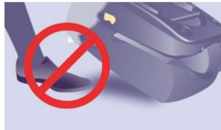
**I** Veillez qu'aucun objet ou pieds, d'un passager assis à l'arrière, n'obstruent les alvéoles d'ancrage et n'empêchent le verrouillage correct de l'ensemble.
