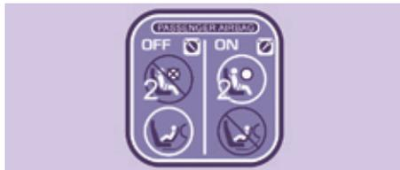
**+** L'airbag passager doit être impérativement neutralisé si un siège enfant est installé dos à la route. Rubrique 4, partie "Enfants à bord".
