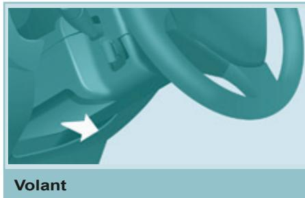
Ajuster la hauteur et la profondeur du volant.
