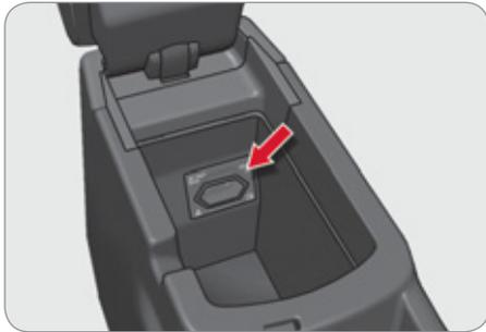
Une prise 230 V / 50 Hz (puissance maxi : 120 W) est installée dans la console centrale.
