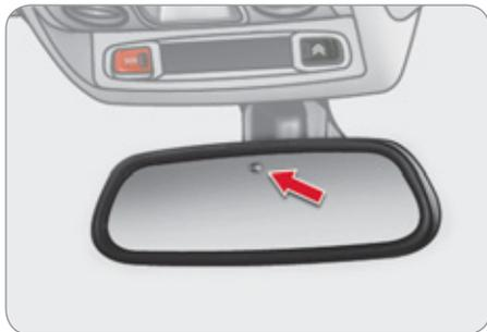
Grâce à un capteur, mesurant la luminosité provenant de l'arrière du véhicule, ce système assure automatiquement et progressivement le passage entre les utilisations jour et nuit.
