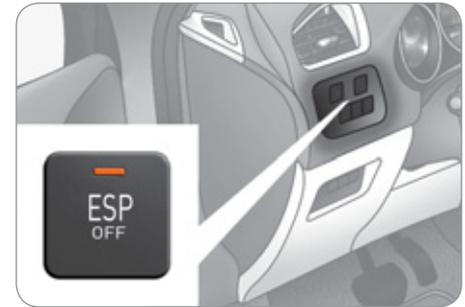
Appuyez sur le bouton «**ESP OFF**», situé à gauche sous le volant.
