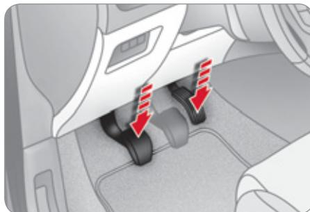
Appuyez sur la pédale d'accélérateur et débrayez (boîte de vitesses manuelle), le frein de stationnement se desserre automatiquement et progressivement lors de l'accélération.
