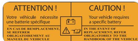
La présence de cette étiquette, notamment avec le Stop & Start, indique l'utilisation d'une batterie au plomb 12 V de technologie et de caractéristiques spécifiques, qui nécessite, en cas de remplacement ou de débranchement, une intervention du réseau CITROËN.
