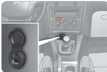
Ce boîtier de connexion, composé d'une prise JACK et d'un port USB, est situé sur la console centrale.
