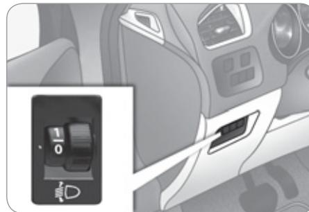
Pour ne pas gêner les autres usagers de la route, les projecteurs à lampes halogènes doivent être réglés en hauteur, en fonction de la charge du véhicule.
