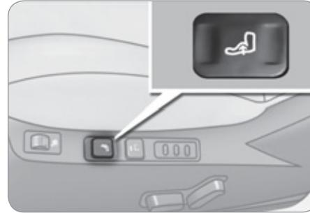
☞ Appuyez sur l'avant ou l'arrière de la commande pour obtenir la poussée et la hauteur du soutien lombaire désiré.
