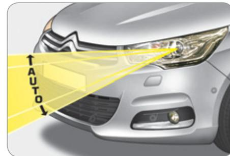
Pour ne pas gêner les autres usagers de la route, ce système corrige, automatiquement et à l'arrêt, la hauteur du faisceau des lampes au xénon, en fonction de la charge du véhicule.
