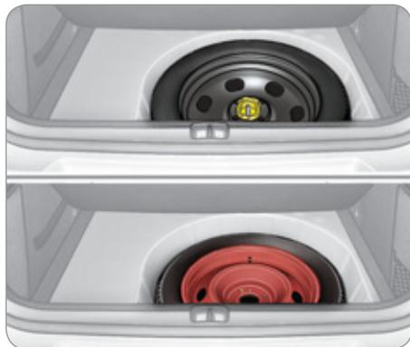
La roue de secours est installée dans le coffre sous le plancher.
