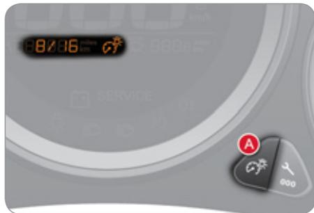
Permet de régler manuellement l'intensité lumineuse du poste de conduite en fonction de la luminosité extérieure. Fonctionne uniquement quand les feux sont allumés, sauf feux diurnes.
