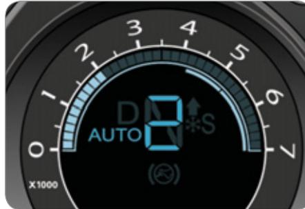
Le rapport de vitesse engagé ou le mode de conduite sélectionné apparaît dans l'afficheur du combiné.
