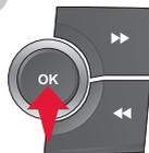
Sélectionner le paramètre à modifier. Le valider en appuyant sur la touche **OK**, puis modifier le paramètre et valider de nouveau pour enregistrer la modification.
