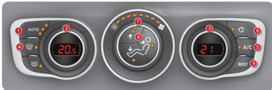
Le système d'air conditionné ne peut fonctionner que moteur tournant, sauf en fonction «REST» et en mode STOP du Stop & Start.
