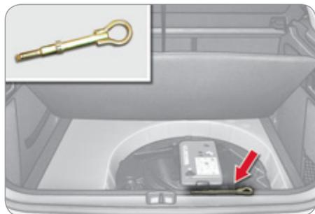
L'anneau de remorquage est installé dans le coffre sous le plancher.
