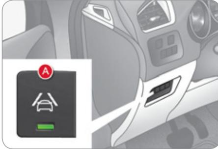
Système détectant le franchissement involontaire d'un marquage longitudinal au sol des voies de circulation (ligne continue ou discontinue).
