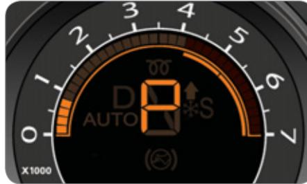
Le mode de conduite sélectionné et/ou le rapport de vitesse engagé apparaissent dans l'afficheur gauche du combiné.
