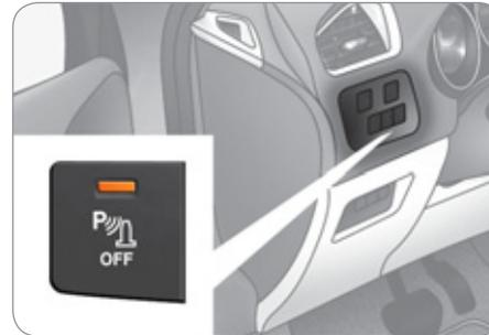
La neutralisation de la fonction s'effectue par un appui sur ce bouton. Le voyant du bouton s'allume.
