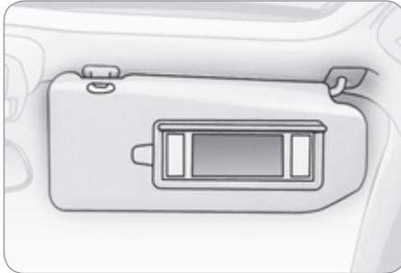
Dispositif de protection contre le soleil venant de face ou de côté et dispositif de courtoisie avec un miroir éclairé.
