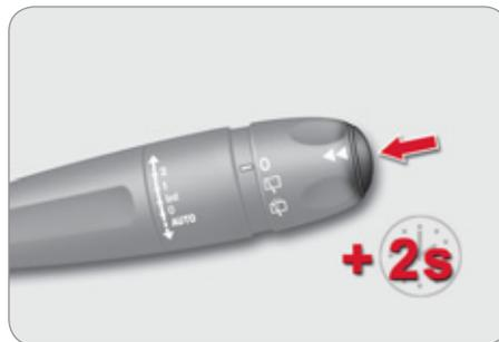
☞ Lorsque le parcours désiré est affiché, appuyez plus de deux secondes sur le bouton, situé à l'extrémité de la commande d'essuie-vitre.
