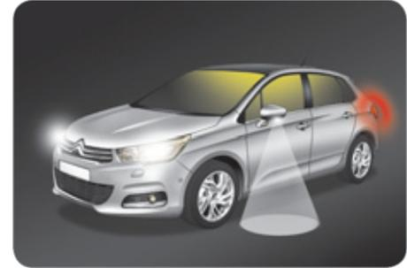
En cas de faible luminosité, détectée par un capteur, l'allumage à distance des feux de croisement et de position, ainsi que les spots latéraux, facilite votre approche du véhicule.
