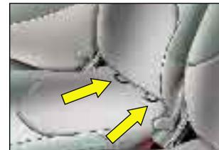
La mauvaise installation d'un siège enfant dans un véhicule compromet la protection de l'enfant en cas de collision. Le système ISOFIX vous permet de limiter ces risques de mauvaise installation. Ce système de fixation ISOFIX vous assure un montage fiable, solide et rapide du siège enfant dans votre véhicule.
