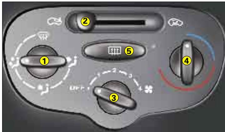
La répartition de l'air pulsé peut être modulée à volonté en plaçant le répartiteur **1** sur une position intermédiaire. Quelle que soit la position choisie, il est toujours possible d'obtenir de l'air aux aérateurs.
