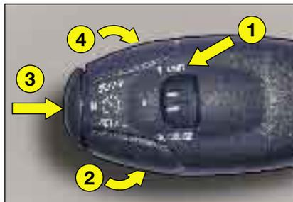
Ce dispositif d'aide à la conduite permet de choisir une vitesse maximale à ne pas dépasser. Celle-ci doit être supérieure à 30 km/h.
