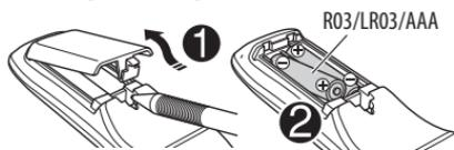
Insérez les piles dans la télécommande en respectant les polarités (+ et -).
