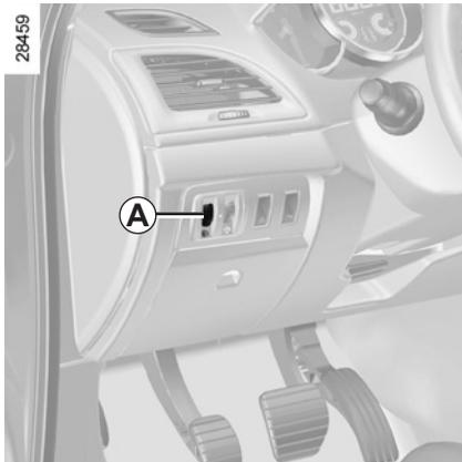
Pour les véhicules qui en sont équipés, la commande **A** permet de corriger la hauteur des faisceaux en fonction de la charge.
