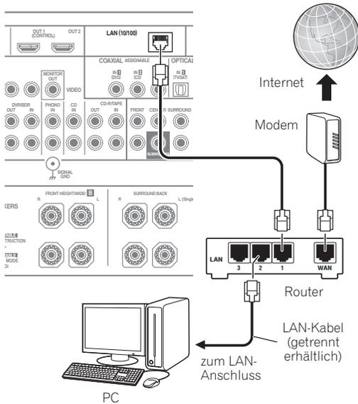
Verbinden Sie den LAN-Anschluss an diesem Receiver mit dem LAN-Anschluss an Ihrem Router (mit oder ohne eingebaute DHCP-Server-Funktion) mit einem direkten LAN-Kabel (CAT 5 oder höher).
