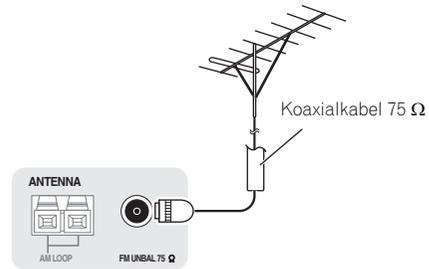
Schließen Sie zur Verbesserung des MW-Empfangs ein etwa 5 m bis 6 m langes, mit Vinyl beschichtetes Kabel an die **AM LOOP**-Anschlüsse an, ohne die mitgelieferte MW-Rahmenantenne zu entfernen.
