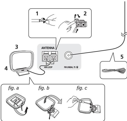
**1 Retirez les protections des deux fils d'antenne AM.**
