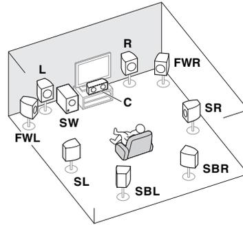
Selon ce plan, les enceintes avant gauche et droite en position haute, comme indiqué en [A], sont remplacées par des enceintes avant gauche et droite en position large (**FWL/FWR**).
