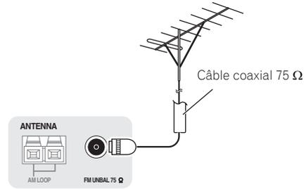
Pour améliorer la qualité de la réception AM, raccordez un fil à gaine en vinyle de 5 m à 6 m de long aux bornes **AM LOOP** sans débrancher l'antenne cadre AM fournie.
