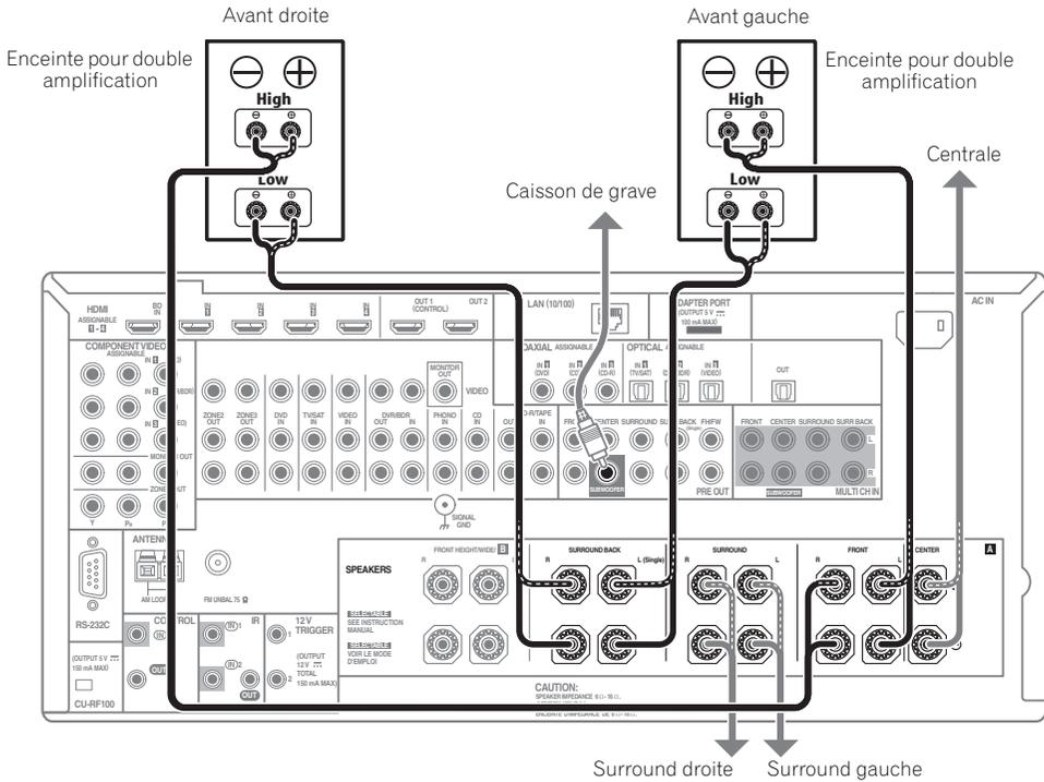
Il y a double amplification lorsque vous reliez les amplificateurs internes hautes et basses fréquences des enceintes à différents amplificateurs externes pour obtenir une meilleure répartition des fréquences. Pour cela, vos enceintes doivent supporter la double amplification (en disposant de bornes distinctes pour les hautes et les basses fréquences) et l'amélioration de la qualité du son dépendra du type d'enceintes utilisé.
