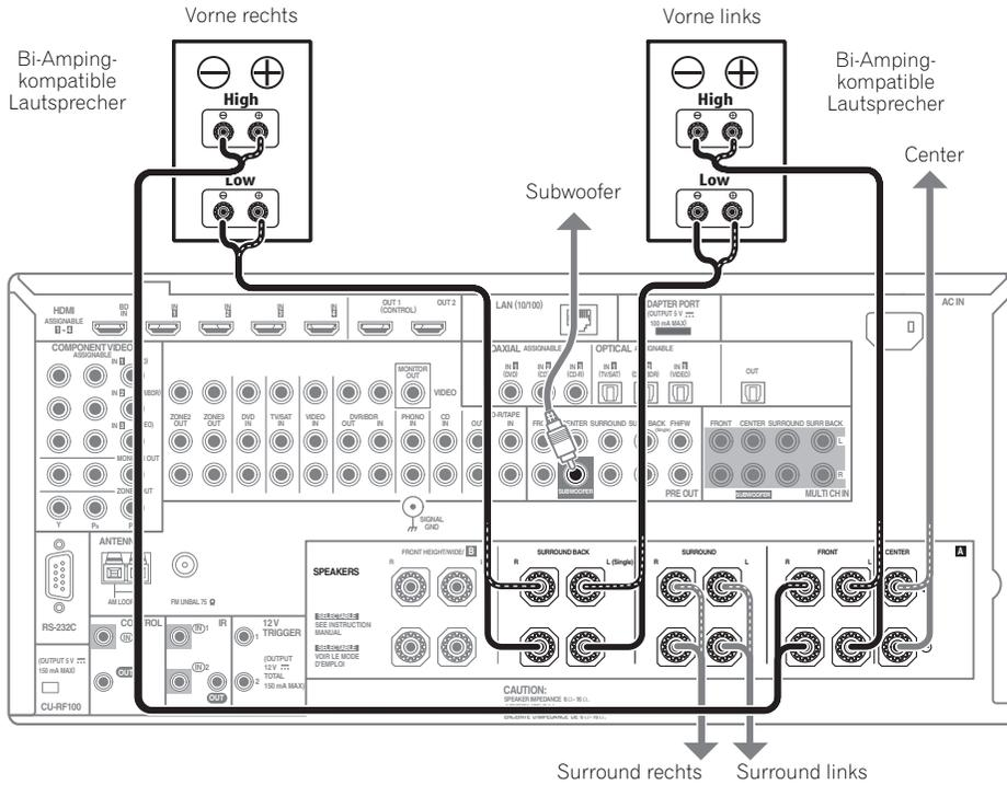
Bi-Amping bedeutet, dass Sie den Hochfrequenztreiber und den Niederfrequenztreiber Ihrer Lautsprecher an verschiedene Verstärker anschließen, um eine bessere Crossover-Leistung zu erzielen. Um dies durchführen zu können, müssen Ihre Lautsprecher Bi-Amping unterstützen (sie müssen über getrennte Anschlüsse für hohe und niedrige Frequenzen verfügen); zudem hängt die Verbesserung des Klangs von der Art der von Ihnen verwendeten Lautsprecher ab.
