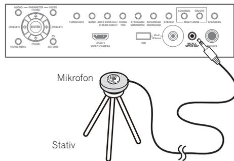
Wenn ein Stativ zur Verfügung steht, stellen Sie das Mikrofon bitte in der Höhe auf, die Ihrer Hörposition entspricht. Wenn Sie kein Stativ haben, verwenden Sie einen anderen Gegenstand zum Anbringen des Mikrofons.<sup>1</sup>
