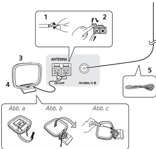
**1 Ziehen Sie die Schutzhülle von beiden MW-Antennendrähten ab.**
