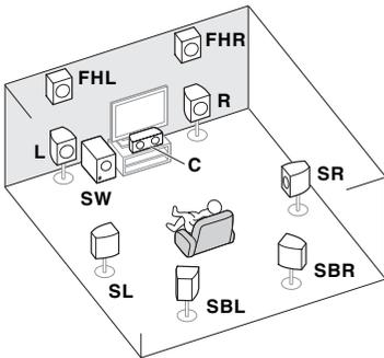
Dans un système surround impliquant 9.1 canaux, les enceintes avant gauche et droite (**L/R**), l'enceinte centrale (**C**), les enceintes avant gauche et droite en position haute (**FHL/FHR**), les enceintes surround gauche et droite (**SL/SR**), les enceintes surround arrière gauche et droite (**SBL/SBR**) et le caisson de grave (**SW**) doivent être raccordés.
