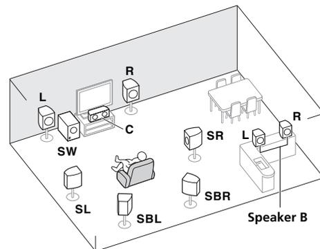
Mit diesen Verbindungen können Sie gleichzeitig 5.1-Kanal-Surroundklang in der Hauptzone mit Stereo-Wiedergabe des gleichen Klangs auf den B-Lautsprechern genießen. Dieselben Verbindungen ermöglichen auch die Ausgabe von 7.1-Kanal-Surroundklang in der Hauptzone, wenn Sie die Lautsprecher B nicht verwenden.
