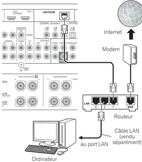
Raccordez la borne LAN de ce récepteur à la borne LAN de votre routeur (avec ou sans fonction de serveur DHCP) par un câble LAN direct (CAT 5 ou supérieur).
