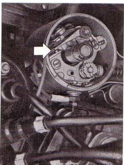
L'écartement des grains de contact de rupteur doit être : 0,4 mm.
