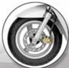
Roue 12" et frein AV à disque Ø 200 mm
