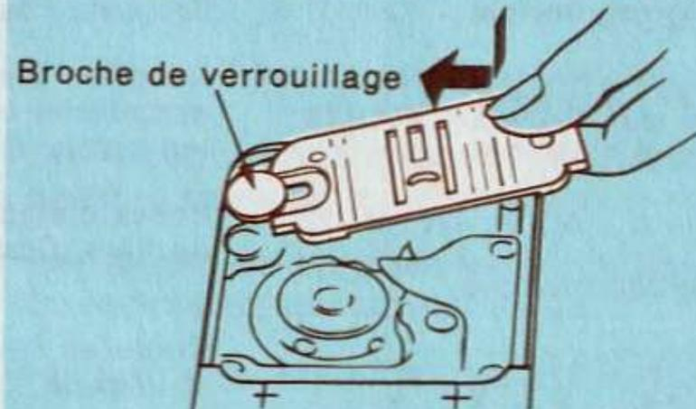
Pour remplacer la plaque à aiguille
