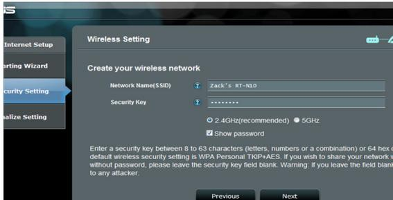
Assignez un SSID et un mot de passe d'accès à l'EA-N66. Utilisez un SSID unique pour éviter les problèmes de conflits de réseau.
