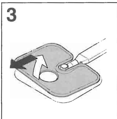
**NB: après le nettoyage des filtres, assurez vous qu'ils sont correctement replacés et que la plaque métallique est correctement mise au fond de la cuve du lave vaisselle.**
