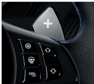
La fonction M Drive permet au conducteur de configurer à sa convenance les principaux composants de la dynamique de conduite. Il peut, par exemple, faire varier la caractéristique du moteur d'extrêmement sportive à dynamique confortable. Les différentes configurations sont activables par pression sur la touche correspondante au volant.
