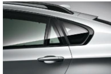
■ **Shadow Line brillant** : baguettes de bas de glace et encadrement des vitres en noir brillant. (Chrome Line de série sur X6 xDrive50i).
