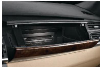
□ **Changeur 6 CD** logé dans la boîte à gants. Avec fente d'insertion unique, fonction scan et lecture aléatoire. Compatibilité MP3.
