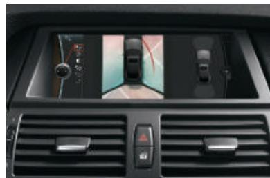
□ La caméra de recul avec fonction Top View filme l'espace à l'arrière et sur les côtés du véhicule, les images apparaissant sur l'écran de contrôle. L'affichage de trajectoires virtuelles vous montre par exemple si une place de parking est assez grande pour pouvoir s'y garer. Une fonction zoom facilite par ailleurs l'accrochage d'une remorque. La caméra de recul est activée automatiquement au passage de la marche arrière.
