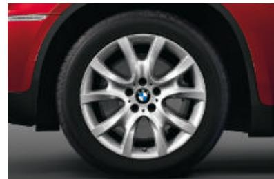
□ Jantes en alliage léger 19" style 257 à rayons en V\*\* avec pneumatiques RSC permettant le roulage à plat. Dimensions : 9 J x 19 pouces, pneumatiques 255/50 R 19.
