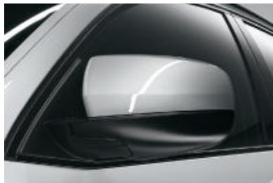
■ **Rétroviseurs extérieurs à réglages électriques et chauffants**, dans la teinte de la carrosserie, avec socles noirs et miroirs asphériques teintés bleu.
