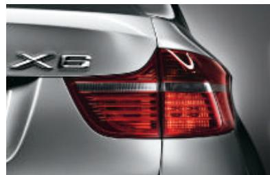
■ **Feux de stop dynamiques**. Ils permettent aux véhicules qui vous suivent de mieux apprécier l'intensité de votre freinage. Lors d'un freinage normal, les feux de stop s'allument sur une large surface. En cas de freinage appuyé, le feu de stop clignote. Ceux qui vous suivent peuvent ainsi faire immédiatement la distinction entre un léger freinage et un freinage d'urgence – pour encore plus de sécurité.
