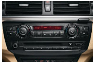
■ **Climatisation automatique bi-zone**, avec recyclage automatique de l'air A/C, filtre pour air recyclé, capteurs de buée et d'ensoleillement, régulation automatique de la température (individuelle pour le conducteur et le passager avant), régulation du débit, affichage et commande via l'écran de contrôle.
