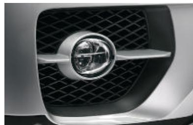
■ **Projecteurs antibrouillard** réalisés suivant la technique des formes libres. Intégrés à la jupe avant, ils garantissent une sécurité accrue par mauvaise visibilité.
