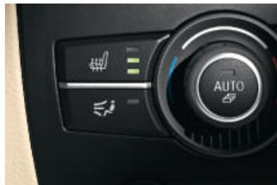
□ **Sièges avant chauffants**: le chauffage à trois niveaux de réglage de la surface des sièges et des dossierins diffuse déjà une agréable chaleur peu après le démarrage.
