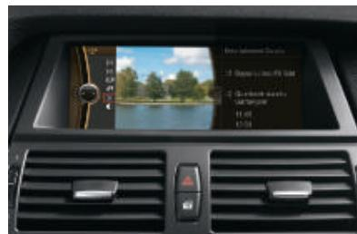
□ Fonction TV. L'écran de contrôle peut être utilisé pour regarder la télévision lorsque le véhicule est à l'arrêt. Cet équipement permet de recevoir les programmes analogiques et numériques terrestres (TNT).
