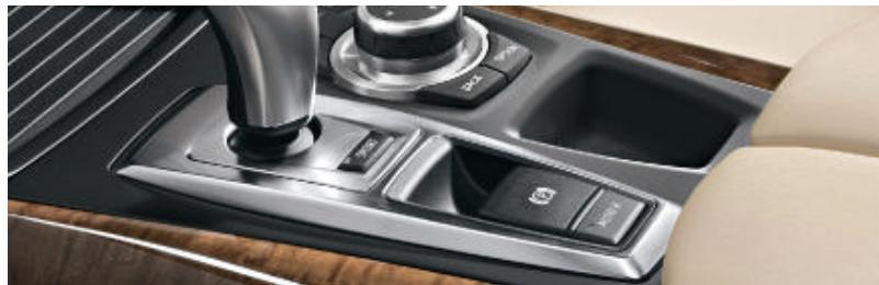
■ Frein de stationnement avec fonction de maintien automatique du véhicule à l'arrêt Auto Hold. Il suffit de tirer ou de pousser ce bouton placé sur la console centrale pour actionner ou relâcher le frein.
