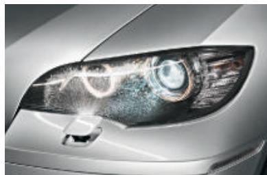
■ **Le lave-projecteur** est le garant d'une luminosité optimale par tous les temps. Lorsque les projecteurs sont allumés, le lave-projecteur est automatiquement mis en marche en même temps que le nettoyage du pare-brise.
