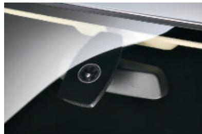
■ **Détecteur de pluie et allumage automatique des projecteurs.** Une fois activé, le détecteur enclenche automatiquement les essuie-glace et commande la cadence du balayage en fonction de l'intensité de la pluie. La fonction intégrée d'allumage automatique des feux de croisement allume ces derniers au crépuscule ou au passage dans un tunnel.
