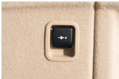
■ **Prises 12 V** : une prise dans le vide-poches avant, une dans la console centrale arrière et une dans le compartiment à bagages.
