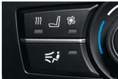
□ **Sièges avant à ventilation active** pour nettement plus de confort. Des ventilateurs placés dans l'assise et le dossier insufflent de l'air à travers les garnissages perforés.
