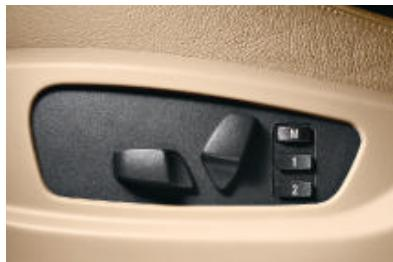
■ **Sièges avant électriques** avec mémoires pour le siège conducteur, la colonne de direction et les rétroviseurs extérieurs.
