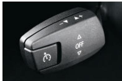
■ Le régulateur de vitesse avec fonction freinage permet une conduite confortable à une vitesse prédéfinie (à partir de 30 km/h).
