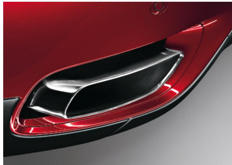
■ **Sorties d'échappement** : le système d'échappement avec deux sorties rectangulaires de la BMW X6 xDrive50i est réalisé en acier inoxydable de haute qualité. Des embouts chromés décorent les sorties.
