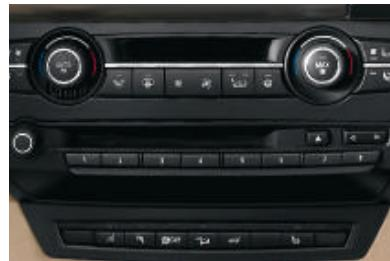
■ Touches de raccourci pour les fonctions des systèmes audio (par exemple des stations radio ou des titres musicaux de CD), de navigation ou du téléphone utilisées le plus souvent par le conducteur et le passager avant. Lorsqu'une fonction a été assignée à l'une de ces huit touches, une simple pression suffit pour l'activer.
