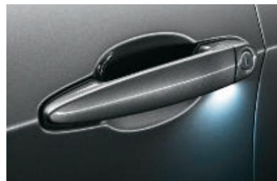
■ **Kit éclairage** avec liseuses à l'arrière, éclairage du bas de l'habitacle à l'arrière, illumination indirecte des vide-poches intégrés aux panneaux de porte, spots de descente de voiture et poignées extérieures de porte avec éclairage intégré. Au déverrouillage du véhicule, la zone d'accès ou de descente est ainsi toujours bien éclairée pour plus de confort et de sécurité.
