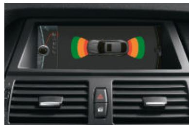
■ Système d'aide au stationnement PDC avant et arrière. Il facilite les manœuvres de stationnement sur les emplacements les plus étroits, la distance entre votre véhicule et un obstacle étant indiquée par des signaux sonore et visuel (sur l'écran de contrôle).
