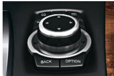
■ «Controller» iDrive. Cette molette-poussoir permet d'accéder à différentes fonctions qui s'affichent sur l'écran de contrôle. Les touches d'accès direct appellent les menus CD, Radio, Navigation et Téléphone. Les touches Menu, Option et Back rendent la commande encore plus simple.
