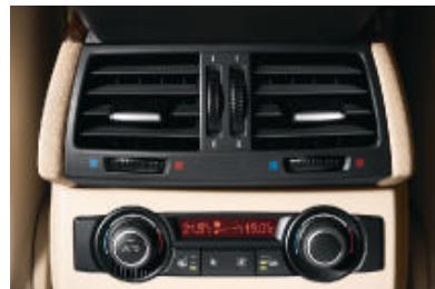
□ **Climatisation automatique à 4 zones**. Équipement similaire à la climatisation automatique bi-zone avec, en plus, réglage individuel de la température à l'arrière via deux molettes et un affichage indépendant. Cet équipement comprend également pour l'arrière des bouches d'aération et le chauffage de bas d'habitacle.
