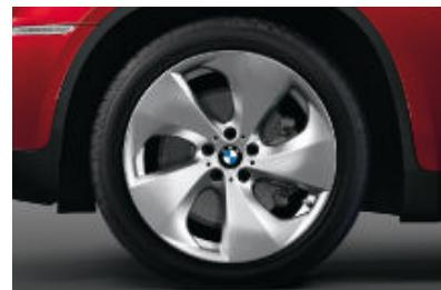
■ Jantes en alliage léger 20" style 297 Aero avec monte pneumatique mixte RSC permettant le roulage à plat. Dimensions : 10 J x 20 pouces à l'avant, pneumatiques 275/40 R 20 ; 11 J x 20 pouces à l'arrière, pneumatiques 315/35 R 20. Uniquement sur ActiveHybrid X6.
