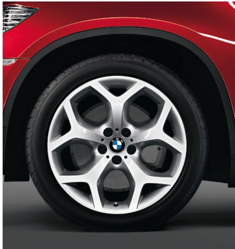
□ Jantes en alliage léger 20" style 214 à rayons en Y\*\* avec monte pneumatique mixte RSC permettant le roulage à plat. Dimensions : 10 J x 20 pouces à l'avant, pneumatiques 275/40 R 20 ; 11 J x 20 pouces à l'arrière, pneumatiques 315/35 R 20. Ces jantes sont peintes en noir en combinaison avec le Pack Performance M.
