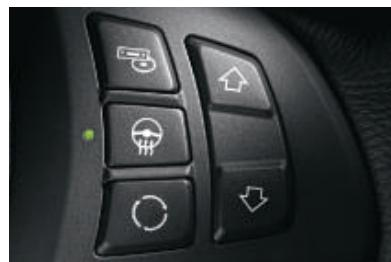
□ Volant chauffant : d'une simple pression sur un bouton, la jante de volant est rapidement chauffée.
