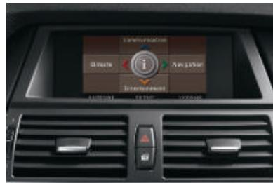
■ Écran de contrôle TFT<sup>1</sup> couleur 8,8 pouces. Il permet d'afficher les fonctions commandées par l'intermédiaire du «Controller» telles que l'ordinateur de bord, l'autoradio, la climatisation ou le système de navigation.
