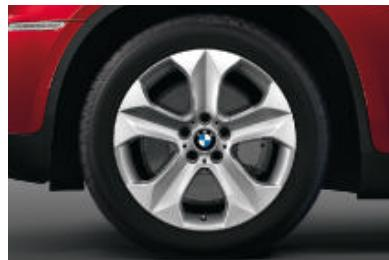
■ Jantes en alliage léger 19" style 232 à rayons en étoile\*\* avec pneumatiques RSC permettant le roulage à plat. Dimensions : 9 J x 19 pouces, pneumatiques 255/50 R 19. De série sur les BMW X6 xDrive35i, X6 xDrive30d et X6 xDrive35d.
