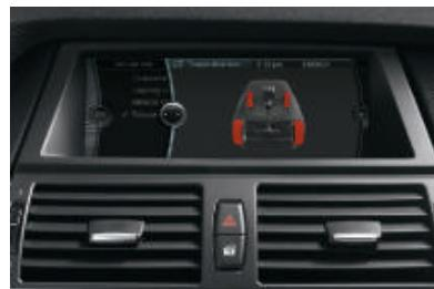
■ Afficheur du Contrôle Dynamique de la Transmission. Il indique la répartition du couple entre les essieux avant et arrière (par la technologie xDrive) et entre les roues arrière (par le Contrôle Dynamique de la Transmission).
