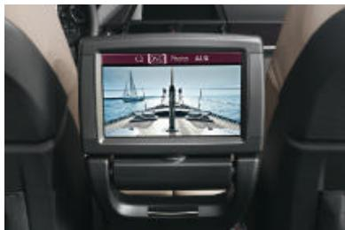
□ **Système DVD** pour l'arrière comprenant un lecteur DVD à commande indépendante avec un écran couleur pivotant de 8 pouces. Avec télécommande sans fil, deux casques d'écoute infrarouges et entrée vidéo. En combinaison avec la fonction TV, il est possible de regarder un programme de télévision à la fois sur les écrans avant (à l'arrêt) et arrière du véhicule.
