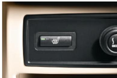
□ **Sièges arrière chauffants** : équipement similaire aux sièges avant chauffants mais à deux niveaux de réglage.
