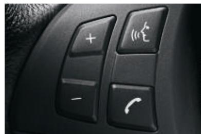
□ Système de commande vocale avancé permettant de sélectionner par la voix notamment les stations de radio, les destinations du système de navigation ou les entrées dans l'annuaire téléphonique, les informations s'affichant simultanément sur l'écran de contrôle.
