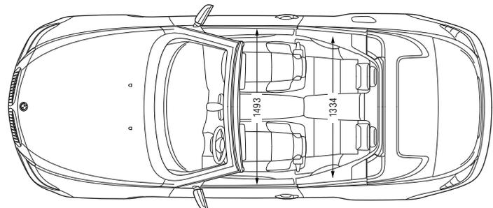
Toutes les cotes sont indiquées en millimètres. Capacité du compartiment à bagages de la BMW M6 Cabriolet 300 à 350 litres et BMW M6 Coupé 450 litres.
