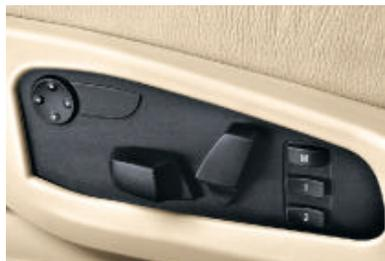
□ **Sièges avant électriques,** avec mémoires pour le siège conducteur, les rétroviseurs extérieurs et la colonne de direction, et basculement automatique du rétroviseur extérieur côté passager au passage de la marche arrière. De série sur BMW 550i.
