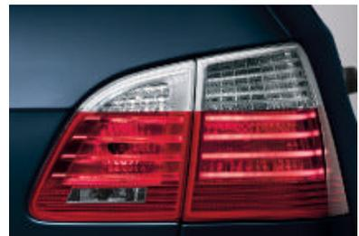
■ **Feux arrière** avec clignotants à DEL et quatre conduits lumineux à DEL horizontaux. Quelles que soient les conditions d'éclairage, votre BMW Série 5 Touring est toujours parfaitement visible. L'utilisation de verre cristal se traduit par une esthétique originale et permet d'observer la technique d'éclairage haut de gamme.
