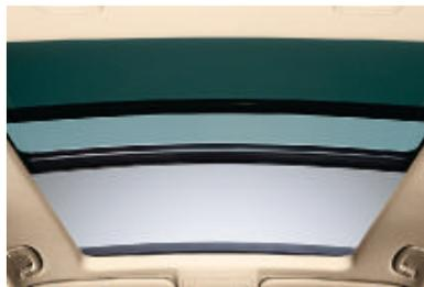
□ **Toit ouvrant panoramique en verre** à ouverture et surface généreuses, avec déflecteur d'air asservi à la vitesse. Les deux parties en verre s'entrebâillent électriquement à l'aide de touches à impulsions. La partie avant est en plus coulissante, de même que le store pare-soleil de ciel de pavillon à commande électrique ; ouverture/fermeture confort et protection anti-pincement.
