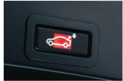
□ **Commande électrique du hayon** : ce dernier s'ouvre automatiquement à l'aide de la clé à télécommande et se ferme grâce au bouton sur le hayon. L'ouverture se fait électrohydrauliquement. En fermant le hayon, le couvre-bagages redescend automatiquement. La hauteur d'ouverture est réglable par l'intermédiaire du système iDrive.
