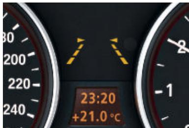
□ **L'avertisseur de franchissement de ligne** détecte grâce à une caméra tout rapprochement involontaire des lignes de délimitation de voie et avertit immédiatement le conducteur par des vibrations dans le volant. Ce système, conçu pour la conduite sur les routes nationales et sur autoroute, peut être activé ou désactivé à l'aide d'une touche sur le volant multifonctions.
