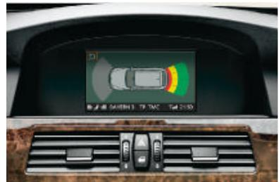
□ **Système d'aide au stationnement PDC avant et arrière**. Il facilite les manœuvres de stationnement sur les emplacements les plus étroits, la distance entre votre véhicule et un obstacle étant indiquée par un signal sonore et représentée sur l'écran de contrôle (de série sur BMW 550i).
