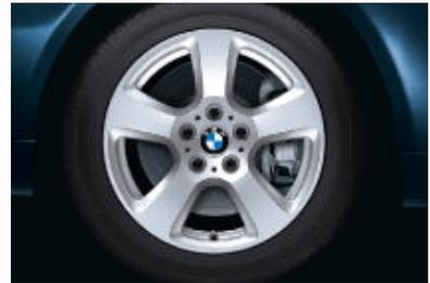
□ **Jantes en alliage léger 17" style 243 à rayons en étoile**", 7,5 J x 17 pouces, pneumatiques 225/50 R 17 (série sur les BMW 525i xDrive, 530i, 530i xDrive, 525d xDrive, 530d et 530d xDrive).
