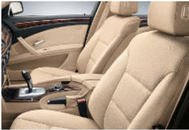
■ **Sièges de série** avec réglage longitudinal manuel, réglages électriques de la hauteur de l'assise et de l'inclinaison du dossier et réglage manuel de l'inclinaison de l'assise (siège conducteur uniquement).
