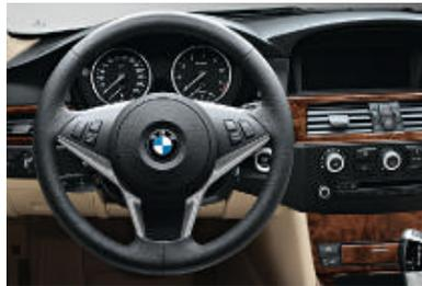
□ **Volant Sport gainé cuir**, à trois branches, avec touches multifonctions, pour une prise en mains parfaite grâce à son petit diamètre (379 mm). Les touches intégrées permettent de commander l'autoradio, le lecteur de CD et le téléphone (option) en cours de route. Avec deux touches librement programmables. De série sur BMW 550i.
