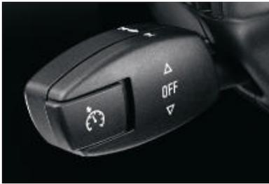
■ **Le régulateur de vitesse avec fonction freinage** permet d'enregistrer la vitesse souhaitée à partir de 30 km/h et la maintient constante (actionnement par le biais du levier placé à gauche sur la colonne de direction).
