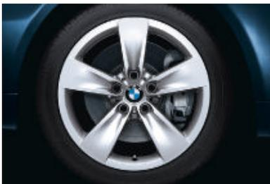
□ **Jantes en alliage léger 18" style 246 à rayons en étoile** avec **pneumatiques RSC permettant le roulage à plat**, 8 J x 18 pouces, pneumatiques 245/40 R 18.
