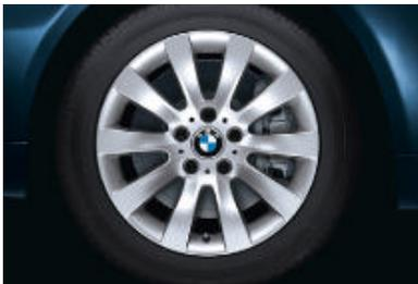
□ **Jantes en alliage léger 17" style 244 à rayons radiaux**", 7,5 J x 17 pouces, pneumatiques 225/50 R 17 (de série sur BMW 535d – de série sur BMW 550i avec **pneumatiques RSC permettant le roulage à plat**).
