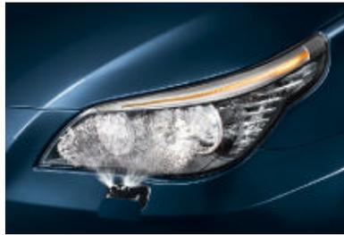
□ Les **lave-projecteurs** garantissent un éclairage optimal par tous les temps. Lorsque les projecteurs sont allumés et que le conducteur active le nettoyage du pare-brise, les lave-projecteurs entrent automatiquement en action.
