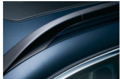
□  **Rails de toit.** Harmonieusement intégrées à l'esthétique du véhicule, elles sont à la base du système de toit modulaire BMW, qui peut accueillir facilement et en toute sécurité bagages, vélos, planches de surf, etc.
