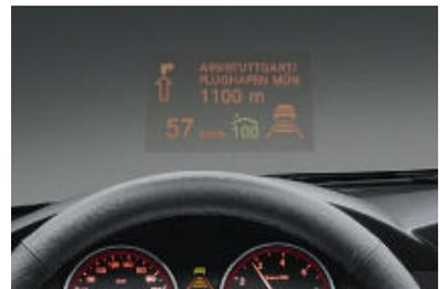
□ **L'affichage tête haute HUD** permet au conducteur d'avoir toutes les informations importantes pour la conduite affichées sur le pare-brise : vitesse du véhicule, indications fléchées du système de navigation, fonctions du régulateur de vitesse actif ACC + et de l'avertisseur de franchissement de ligne (en fonction des équipements du véhicule). De série sur BMW 550i.
