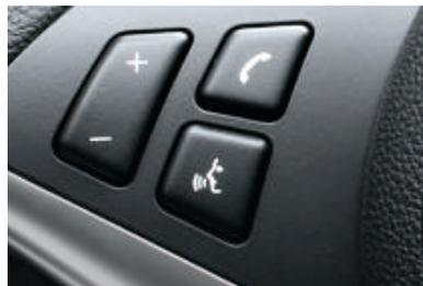
□ **Le système de commande vocale avancé** permet de commander tout en roulant certaines fonctions telles que la recherche d'une station de radio, une destination ou une entrée figurant dans l'annuaire de téléphone. Elles apparaissent simultanément sur l'écran de contrôle.
