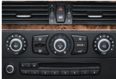
□ **Climatisation automatique bi-zone à fonctionnalités étendues** avec recyclage automatique de l'air, capteurs solaire et de buée, réglage séparé conducteur/passager de la température à l'avant et réglage automatique du débit d'air. L'affichage et les réglages se font par le biais de l'écran de contrôle.
