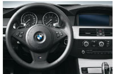
**Volant M gainé cuir** : il tient parfaitement en mains grâce à une jante de volant plus épaisse et aux repose-pouces. Les touches multifonctions intégrées permettent de commander l'autoradio, le lecteur de CD et le téléphone (option) tout en conduisant. (Sur la photo avec boîte automatique Sport à 6 rapports).
