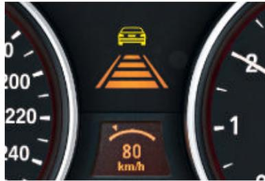
□ **Régulateur de vitesse actif ACC +.** Système d'aide à la conduite spécialement conçu pour un confort et une sécurité accrues en circulation en files ininterrompues. Il combine les fonctions de régulateur de vitesse – avec maintien actif d'une distance de sécurité par rapport au véhicule qui précède – et de freinage jusqu'à arrêt complet et redémarrage automatique.
