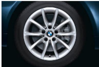
□ **Jantes en alliage léger 17" style 245 à rayons en V** avec **pneumatique RSC permettant le roulage à plat**, 8 J x 17 pouces, pneumatiques 245/45 R 17 (indisponible sur les versions xDrive).
