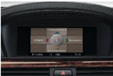
□ **Système de navigation Business** avec lecteur combiné CD/DVD de navigation compatible MP3, « Controller » iDrive et touches d'accès direct aux fonctions iDrive, touches de raccourci programmables. Guidage par flèches et cartes sur un écran de 6,5 pouces.
