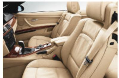
■ **Sièges avant**, avec système « Easy-Entry » (sièges avant coulissant pour faciliter l'accès aux places arrière).
