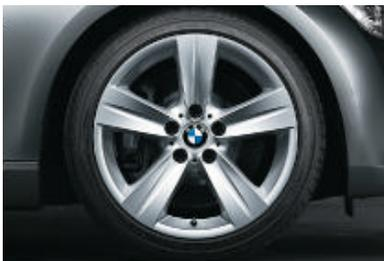
□ **Jantes en alliage léger 18" style 189 à rayons en étoile, avec monte pneumatique mixte RSC permettant le roulage à plat.** Dimensions : 8 J x 18 pouces à l'avant, pneumatiques 225/40 R 18 ; 8,5 J x 18 pouces à l'arrière, pneumatiques 255/35 R 18.
