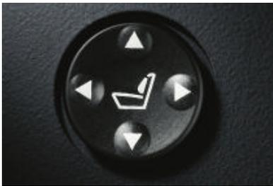
□ **Les sièges avant avec soutien lombaire à réglages électriques en hauteur et en profondeur** assurent une position assise ergonomique et soulagent les muscles dorsaux.
