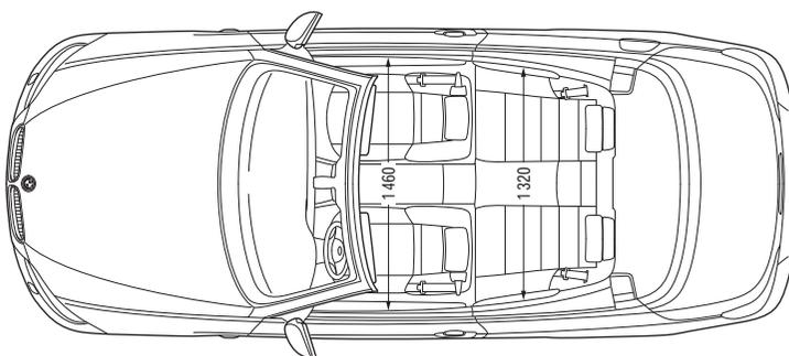
Toutes les cotes sont indiquées en millimètres. Capacité du compartiment à bagages : 210 – 350 litres (suivant VDA).
