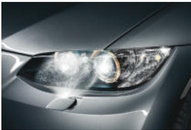
■ **Le lave-projecteurs** est le garant d'une luminosité optimale par tous les temps. Lorsque les projecteurs sont allumés, le lave-projecteurs est automatiquement mis en marche en même temps que le nettoyage du pare-brise.
