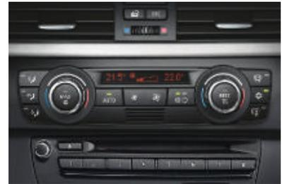
■ **Climatisation automatique bi-zone** avec AUC, filtre microporeux, capteur de buée et d'ensoleillement, et touche pour chaleur résiduelle. Avec réglage individuel de la température à gauche et à droite, boîte à gants climatisée dans la console centrale, ventilation et climatisation des places arrière. Avec mode de climatisation spécifique au cabriolet en combinaison avec un système de navigation.
