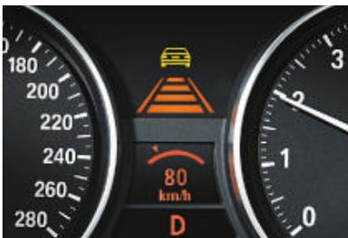
□ **Régulateur de vitesse actif ACC** (disponible sur les modèles 6 cylindres). Il permet une conduite détendue à une vitesse prédéfinie. Sur la route, votre BMW adapte sa vitesse à celle du véhicule qui la précède et, grâce à un système radar, maintient automatiquement une distance de sécurité prédéfinie. La fonction freinage garantit que la vitesse reste constante même dans les descentes.
