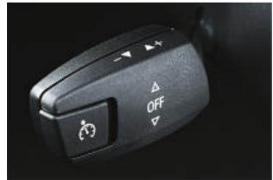
■ **Régulateur de vitesse** avec fonction freinage (sauf sur les BMW 320i 170 ch et 320d 177 ch). A partir de 30 km/h environ, il mémorise et maintient la vitesse souhaitée (affichage sur l'écran à cristaux liquides). Après une accélération, le régulateur rétablit automatiquement la vitesse enregistrée au préalable. Lorsque le conducteur freine, la fonction est désactivée.
