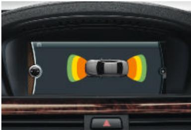
□ **Système d'aide au stationnement PDC<sup>1</sup>** avant et arrière ou uniquement arrière : il facilite les manœuvres de stationnement dans un espace réduit. D'autre part, il indique que votre véhicule s'approche d'un obstacle par un signal acoustique (ou optique sur l'écran en combinaison avec le système de navigation, voir photo).
