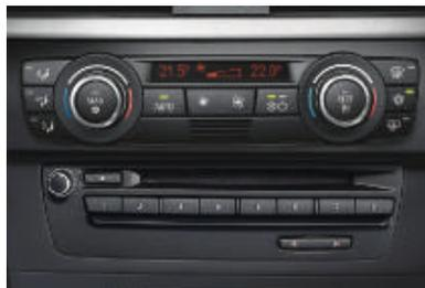
□ **Touches de raccourci** pour les fonctions des systèmes audio et de navigation ainsi que du téléphone utilisées le plus souvent par le conducteur et le passager avant. Lorsqu'une fonction a été assignée à l'une de ces huit touches, une simple pression suffit pour l'activer rapidement.
