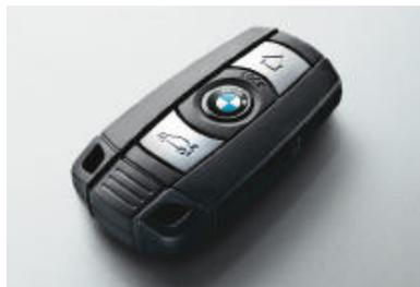
□ **Accès Confort.** Il permet de verrouiller et de déverrouiller la voiture, de fermer le toit, mais aussi de la faire démarrer directement à l'aide du bouton de démarrage « Start/Stop » sans manipuler la clé à télécommande. Pour cela, il suffit de porter cette dernière dans la poche de votre pantalon, dans votre porte-documents ou dans votre sac à main par exemple.
