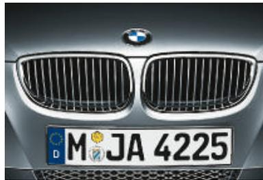
■ **Calandre** avec contour et barres longitudinales chromés. Les barres longitudinales restent noires sur les BMW 320i 170 ch et BMW 320d 177 ch.
