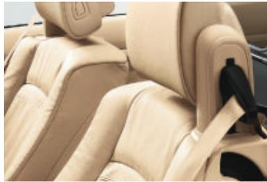
■ **Le système de ceintures de sécurité intégrées aux sièges** garantit un maintien parfait quelle que soit la position assise pour une protection optimale des occupants et facilite l'accès aux places arrière.
