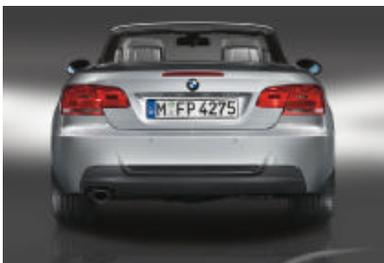
**Jupe arrière** : pour une esthétique plus sportive et une meilleure aérodynamique. Le diffuseur arrière améliore en effet la portance négative au niveau du train arrière et augmente l'appui à haute vitesse.
