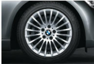
□ **Jantes en alliage léger 17" style 187 à rayons radiaux**, 8 J x 17 pouces, pneumatiques RSC permettant le roulage à plat 225/45 R 17.
