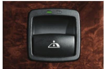
■ **Interrupteur central** permettant d'ouvrir entièrement le toit rigide rétractable et les vitres latérales. Il suffit de le tirer brièvement pour profiter, quelque 22 secondes plus tard, de la conduite cheveux au vent.
