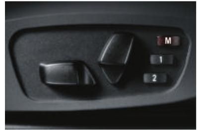
■ **Sièges avant électriques** (hauteur de l'assise et du dossier, position longitudinale et inclinaison), avec mémoires conducteur et rétroviseurs extérieurs (avec basculement automatique du rétroviseur au passage de la marche arrière). Possibilité d'enregistrer deux positions du siège conducteur et des rétroviseurs extérieurs.
