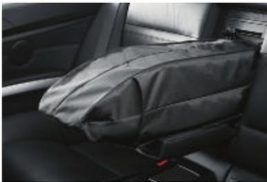
□ **Le sac à skis** (en combinaison avec la trappe à skis) permet de transporter en toute sécurité jusqu'à quatre paires de skis même si quatre personnes sont à bord. Rangé, il prend peu de place et reste à l'abri des regards.
