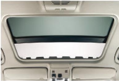
□ **Toit ouvrant électrique en verre**, coulissant et relevable, avec déflecteur et ouverture confort par la télécommande.
