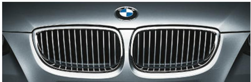
■ **Calandre** avec contour et barres longitudinales chromés. Les barres longitudinales restent noires sur les BMW 320i, 320d et 320d xDrive.
