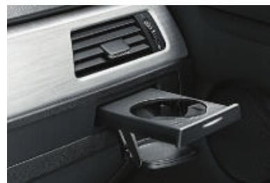
□ **Kit rangement** avec filets au dos des sièges avant, porte-boissons escamotables au-dessus de la boîte à gants et deux porte-boissons dans l'accoudoir central arrière. Cet équipement est complété dans le coffre à bagages par des filets, un porte-sacs, une bande élastique et une prise 12 V.
