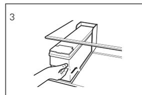
**REMARQUE:** Si le réservoir n'est pas correctement inséré, l'eau de la buse de remplissage se répandra sur la clayette.
