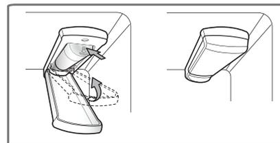
3 Une fois le filtre à eau remplacé, faites couler 9.5 litres d'eau (laissez couler pendant cinq minutes environ) pour éliminer l'air emprisonné et les contaminants du système.
