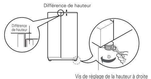
**Si la hauteur de la porte du compartiment du congélateur est différente de la hauteur de la porte du compartiment du réfrigérateur**
