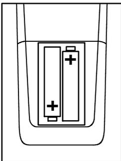
**Les piles :** Enlever la trappe au dos de la télécommande et mettez 2 piles de 1.5 V TYPE LR06.
