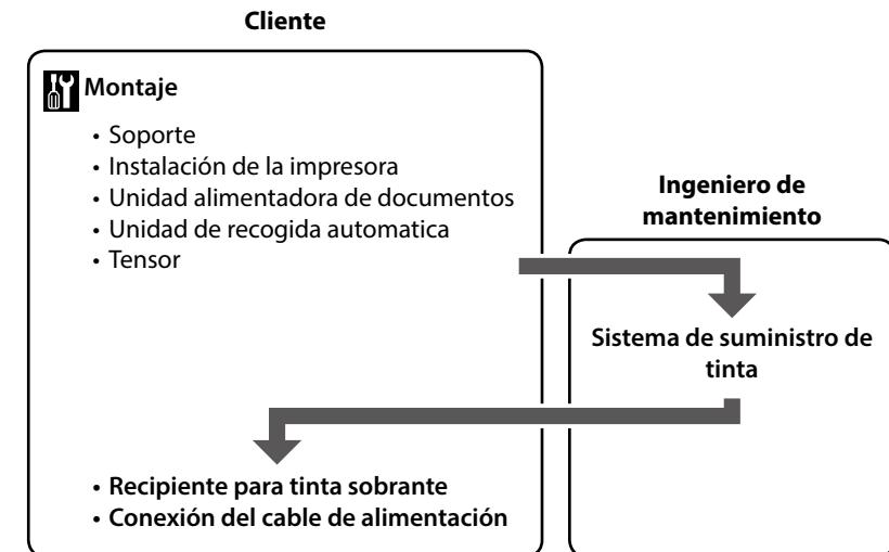
Contacte um engenheiro de serviço para colocar o "Sistema de fornecimento da tinta". Tentar a execução destas tarefas por conta própria pode causar mau funcionamento ou danos na máquina, anulando a sua garantia.
