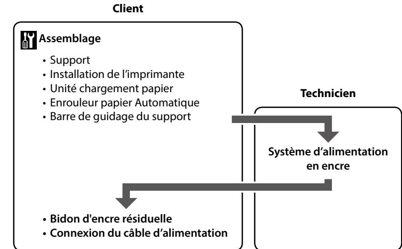
Um das „Ink Supply System“ anzubringen, wenden Sie sich an einen Servicetechniker. Sollten Sie versuchen, diese Arbeiten selbst durchzuführen, kann dies zu Fehlfunktionen des Geräts oder Defekten am Produkt führen und der Garantieanspruch verfällt.
