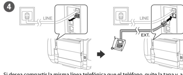
Si desea compartir la misma línea telefónica que el teléfono, quite la tapa y, a continuación, conecte el teléfono al puerto EXT.
