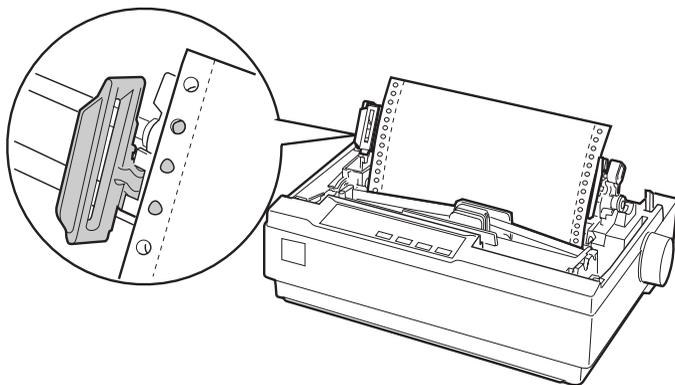
8. Pour séparer le papier vierge du papier imprimé, fixez le guide papier en le tenant horizontalement et en accrochant ses entailles sur les pattes de fixation de l'imprimante. Faites ensuite glisser le guide papier vers l'arrière de l'imprimante jusqu'à ce que vous entendiez un déclic.
