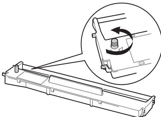
5. Insérez la cartouche de ruban dans l'imprimante, de la manière illustrée, puis appuyez fermement des deux côtés de la cartouche pour que les crochets en plastique pénètrent dans les fentes de l'imprimante.
