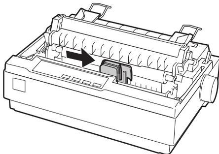
4. Tournez le bouton de tension du ruban dans le sens de la flèche afin de tendre le ruban pour faciliter son installation.
