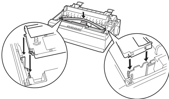
6. En vous aidant d'un objet pointu, notamment un stylo à bille, faites passer le ruban entre la tête d'impression et le guide ruban. Tournez le bouton de tension du ruban pour faciliter sa mise en place. Il ne doit être ni tordu, ni froissé.
