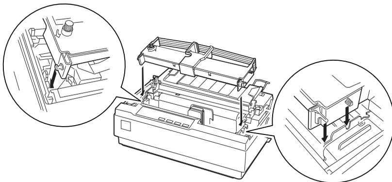
7. Tournez le bouton de tension du ruban pour faciliter sa mise en place. Il ne doit être ni tordu, ni froissé.
