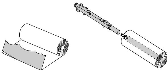
5. Fixez l'axe et le rouleau de papier sur le support de papier rouleau. Orientez le rouleau de manière à ce que le papier soit chargé par le bas du rouleau. Mettez l'imprimante sous tension.
