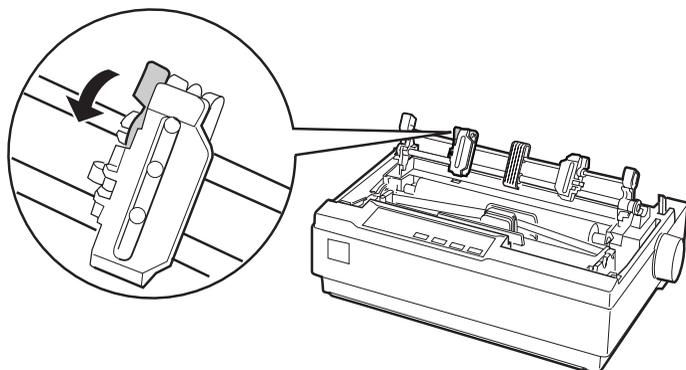
5. Insérez le papier dans la fente d'introduction inférieure ou dans la fente d'introduction arrière, de la manière illustrée ci-dessous, puis tirez-le vers le haut. Positionnez le papier en utilisant la règle qui figure sur l'imprimante comme repère. L'impression commence à droite du repère **0**.
