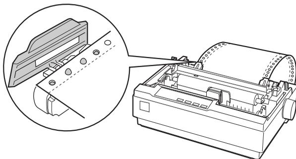
5. Pour séparer le papier vierge du papier imprimé, fixez le guide papier en le tenant horizontalement et en accrochant ses entailles sur les pattes de fixation de l'imprimante, de la manière illustrée ci-dessous. Faites ensuite glisser le guide papier vers l'avant de l'imprimante jusqu'à ce que vous entendiez un déclic.
