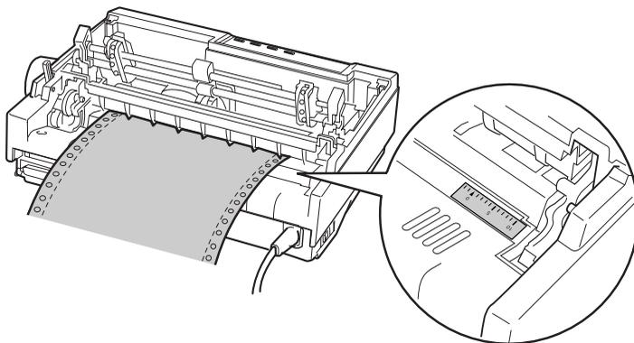
6. Faites glisser la roue à picots gauche de façon à ce que ses picots se trouvent au niveau des perforations du papier, puis verrouillez la roue. Faites ensuite glisser la roue à picots droite en fonction de la largeur du papier, mais ne la verrouillez pas. Positionnez le support papier à mi-chemin entre les deux roues à picots.
