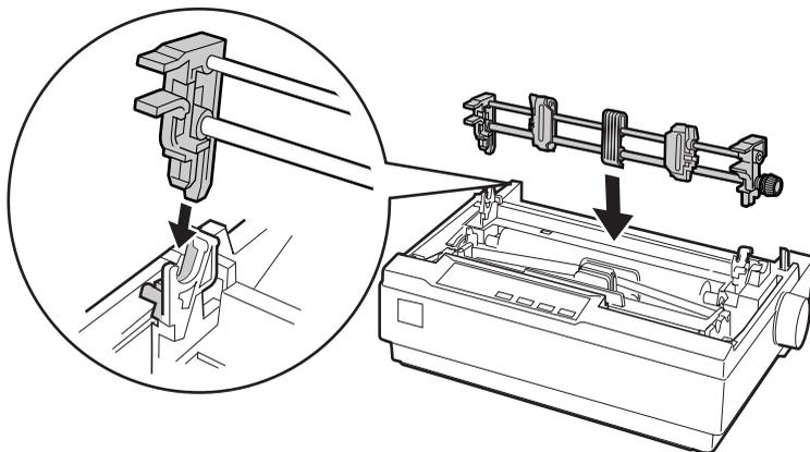
*Pour les utilisateurs du modèle LX-1170 :* Tenez le tracteur tirant des deux mains. Enfoncez le tracteur sur la fente de fixation, sur le dessus de l'imprimante, puis inclinez-le de la manière illustrée ci-dessous. Lorsque vous enfoncez le tracteur sur les pattes, vous devez sentir les entailles s'enclencher.
