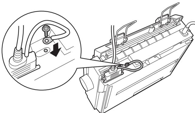
3. Branchez l'autre extrémité du câble sur le port d'interface parallèle de l'ordinateur. (Si cette extrémité du câble est munie d'un fil de mise à la terre, raccordez-le au connecteur de masse situé à l'arrière de l'ordinateur.)
