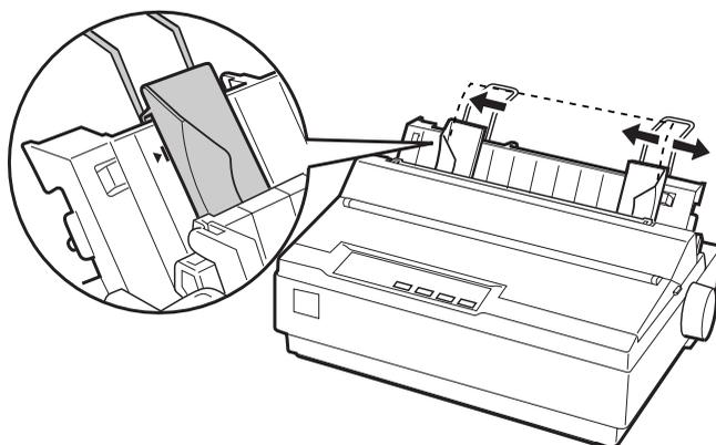
4. Insérez fermement une feuille entre les guides latéraux jusqu'à ce que vous rencontriez de la résistance. L'imprimante charge la feuille automatiquement et commence l'impression du test automatique.
