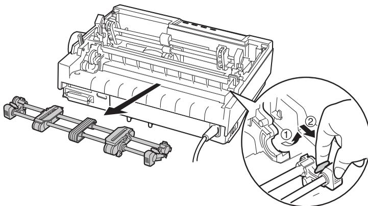
3. Déplacez le tracteur vers l'avant jusqu'à la fente de fixation, sur le dessus de l'imprimante, puis inclinez-le de la manière illustrée ci-dessous. Lorsque vous enfoncez le tracteur sur les pattes, vous devez sentir les entailles s'enclencher.
