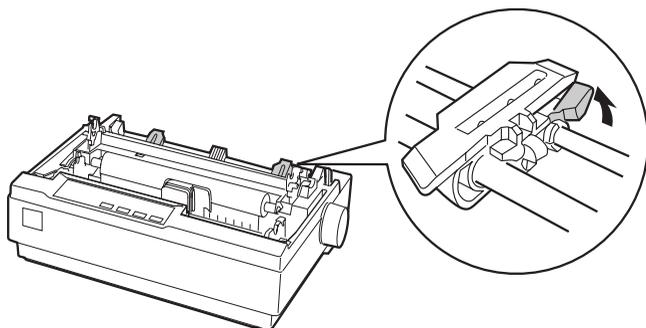
3. Faites glisser la roue à picots gauche en vous aidant de la règle qui figure sur l'imprimante. L'impression commence à droite du repère **0**. Repoussez le levier de verrouillage de la roue à picots pour verrouiller celle-ci. Faites ensuite glisser la roue à picots droite en fonction de la largeur du papier, mais ne la verrouillez pas. Positionnez le support papier à mi-chemin entre les deux roues à picots.
