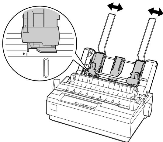
6. Tirez les leviers de maintien du papier complètement vers l'avant jusqu'à ce que les guides latéraux se rétractent et s'ouvrent, permettant ainsi le chargement du papier.
