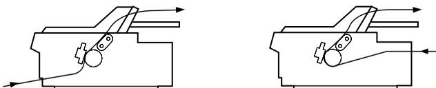
13. Une fois l'impression terminée, ouvrez le capot du guide-papier, puis détachez le document imprimé au niveau du pointillé de séparation le plus proche de la fente de sortie.
